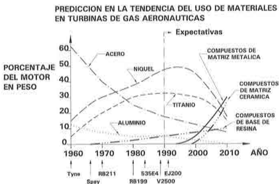
Figura 1.1: Expectativas del uso de materiales en turbinas de gas aeronáuticas, de acuerdo a un estudio realizado por la empresa Rolls Royce.
