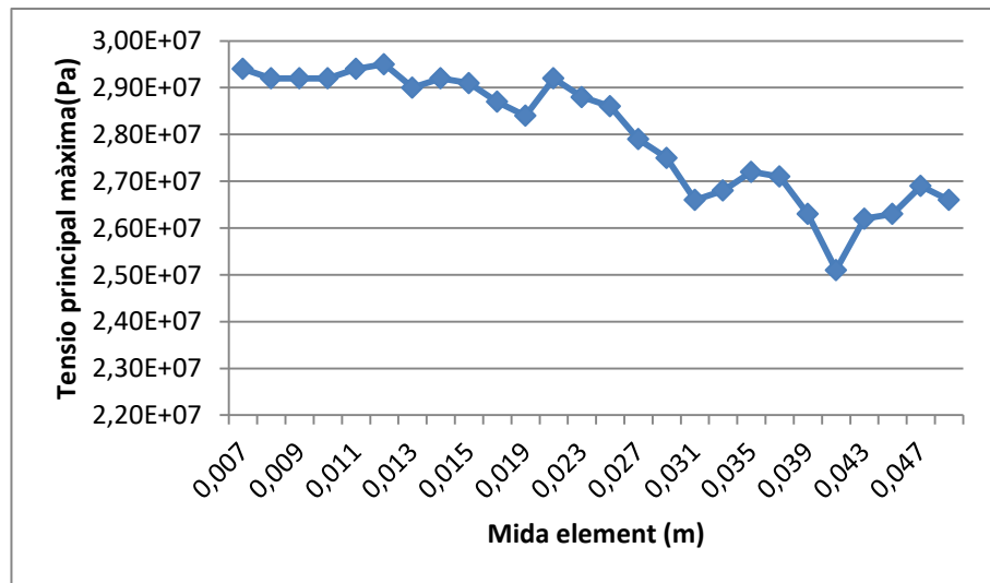
Figura 7.2: Gràfic de la tensió principal màxima en funció de la mida de l'element del mallat
