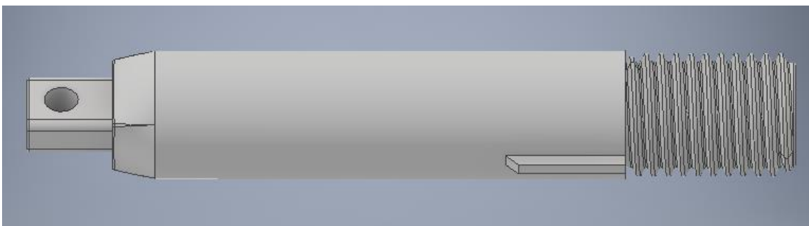
Figura 6.23: Disseny de l'eix de la pròtesi
