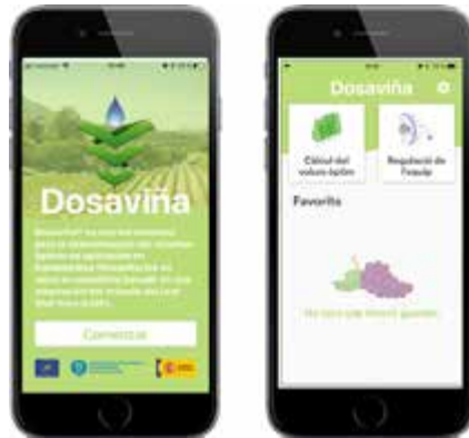
Figura 31. Pantalla de inicio y pantalla para la selección del modo de empleo de Dosavina. Cálculo del volumen óptimo (viña) o regulación del equipo
