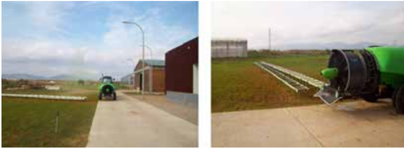
Figura 39. Momentos de los ensayos de campo en Agropolis (UMA-UPC) para el desarrollo de una nueva propuesta para la determinación de la deriva potencial en pulverizadores hidroneumáticos con el banco de deriva.
