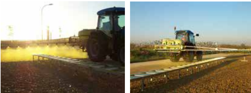
Figura 37. Ensayos para el desarrollo de la nueva norma ISO 22401 para la determinación de la deriva potencial en pulverizadores hidráulicos. Se observa el método para el desarrollo de la norma utilizando el banco de deriva diseñado por AAMS-Salvarani, S.A. ( www.aams-salvarani.com )
