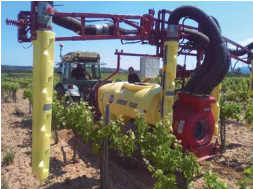
Figura 21. Equipo Iris 2 (Illemo Hardi, S.A.U.) modificado para la aplicación variable de fitosanitarios en viña en base a mapas. Ensayos en el Plà del Penedès (cortesía de Andreu Piñol).
