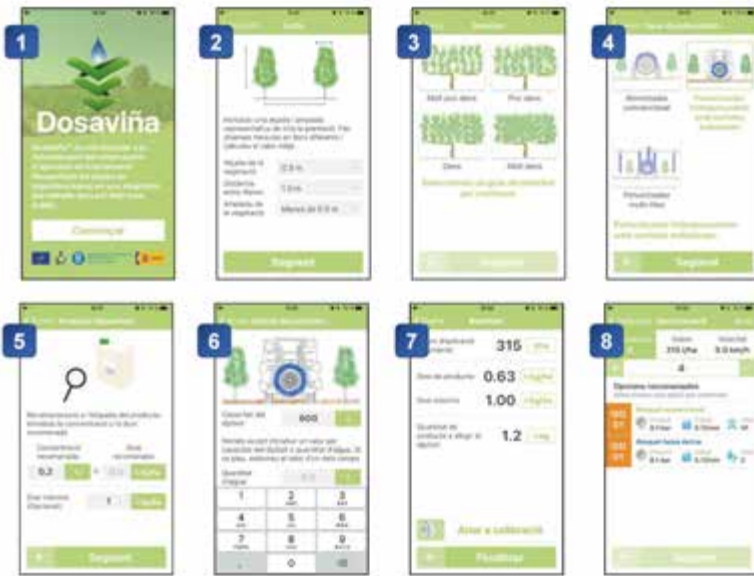
Figura 29. Esquema de funcionamiento de la App DOSAVIÑA: 1. Pantalla de inicio; 2. Entrada de datos de las características estructurales de la plantación; 3. Entrada de datos de la densidad de vegetación; 4. Selección del tipo de equipo de aplicación; 5. Información de la etiqueta del producto fitosanitario; 6. Información sobre la capacidad del depósito; 7. Primera pantalla de resultados: volumen de aplicación y cantidad de producto fitosanitario; 8. Segunda pantalla de resultados: presión de trabajo, velocidad de avance, número y tipo de boquillas recomendado.
