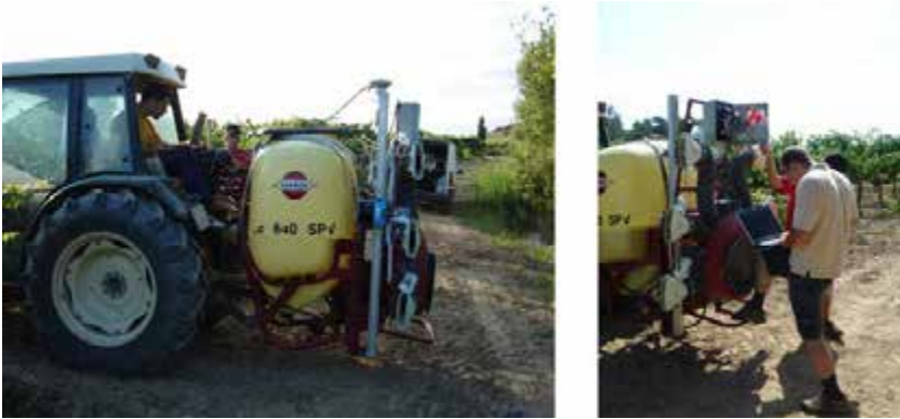
Figura 14. Montaje y puesta a punto en campo del primer prototipo de aplicación variable con sensores de ultrasonidos y LiDAR desarrollado por la Unidad de Mecanización Agraria de la Universitat Politècnica de Catalunya (Gil et al., 2013)
