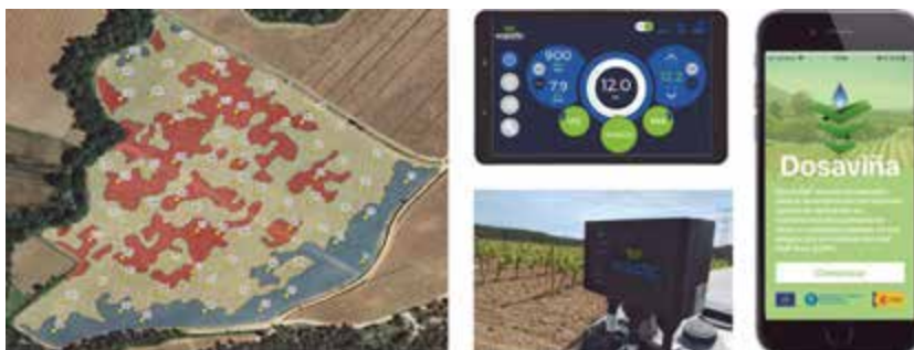
Figura 25. Mapa de variabilidad de vegetación de la finca Fransola (Miguel Torres, S.A.) y dispositivo Waatic (Estel Grup - http://estelgrup.com ) con el que, juntamente con la aplicación Dosaviña ® se ha dotado al equipo para la realización de la aplicación variable en el proyecto Go-Phytovid ( https://www.gophytovid.es )
