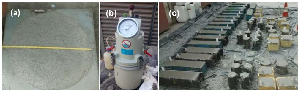
Figura 1.- a) Extensión de flujo; b) % de aire ocluido; c) Probetas moldeadas
