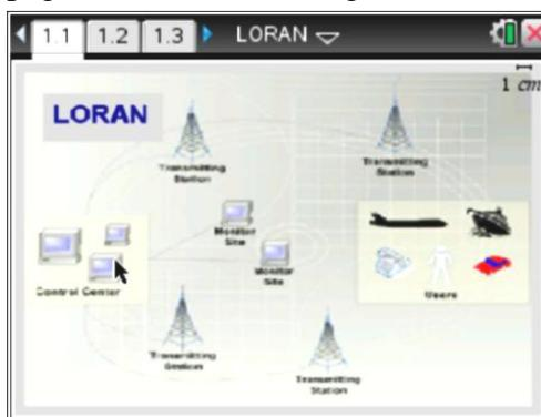
*El Long Range Navigation, LORAN es un sistema de navegación de largo alcance. Esta tecnología proporciona información de la posición de un avión o de un barco midiendo la diferencia de tiempo en microsegundos, entre la llegada de dos señales de radio sincronizadas procedentes de dos estaciones transmisoras que se encuentran en tierra.*
