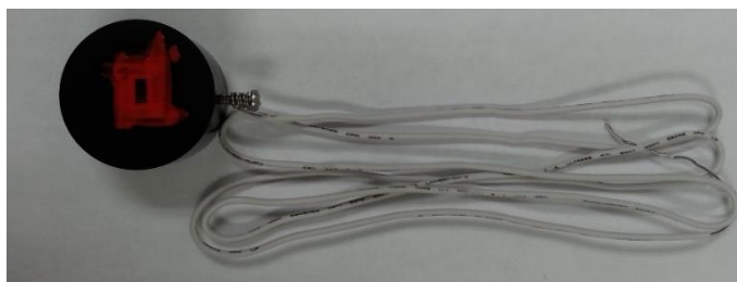
Fig. 3.5. The corrosion coupon
