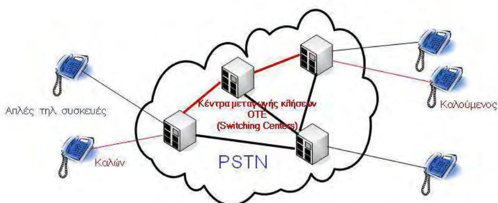
Εικόνα 1: Δίκτυο μεταγωγής κυκλώματος.
