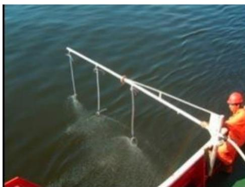
Imagen 37: Brazo de dispersante y mangueras pulverizadoras. <https://www.nauticexpo.es> 2020
