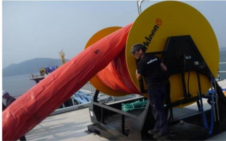
Imagen 23: Barrera de contención 2. Markleen oil spill technology 2016
