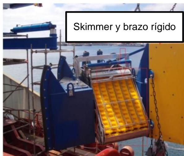
Imagen 19: Skimmer de la grúa y parte del brazo rígido. Elaboración propia 2017
