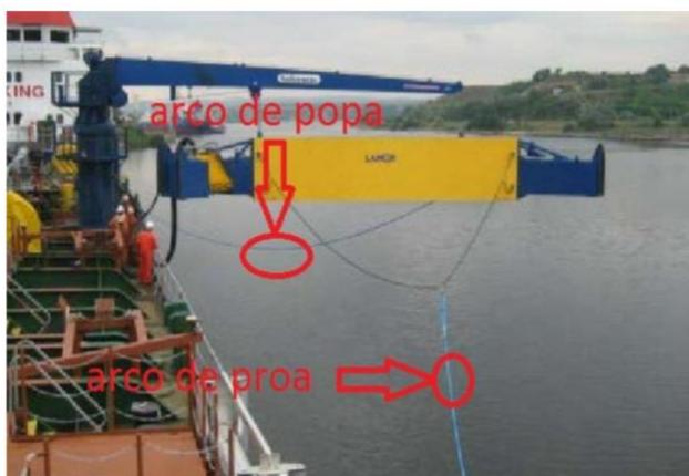
Imagen 10: Posición de los cabos, brazo rígido. B/T Mencey 2016
