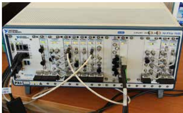
Рис. 5. Внешний вид задающего генератора на базе модулей PXI National Instruments
