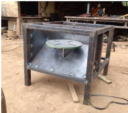
Gambar 5 Pemasangan corong pengeluaran
