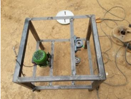
Gambar 4 Pemasangan motor listrik
