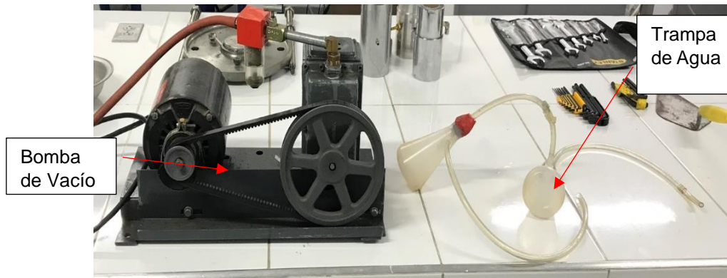
Figura 18. Bomba de Vacío y Trampa de agua.
