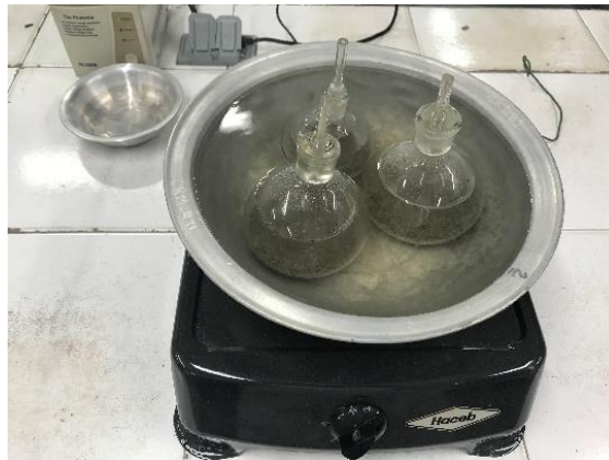
Figura 11. Determinación de la gravedad específica (Gs) con picnómetros.
