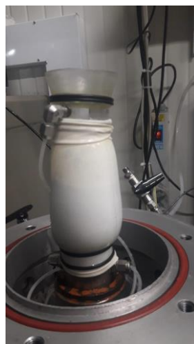
Figura 46. Gas producido al despresurizar la cámara para muestra preparada con arena previamente tratada con peróxido de hidrógeno y calcinada más peróxido de hidrógeno al 4% de concentración.
