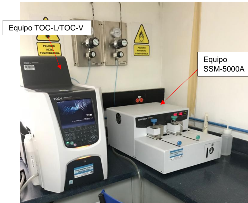
Figura 20. Equipo SSM-5000A Solid Sample Combustion Unit
