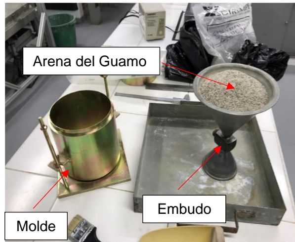
Figura 12. Determinación de relación de vacíos máxima.
