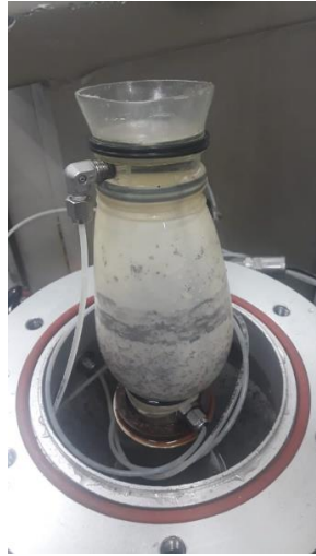
Figura 45. Gas producido al despresurizar la cámara para muestra preparada con 1% de materia orgánica más peróxido de hidrógeno al 4% de concentración.
