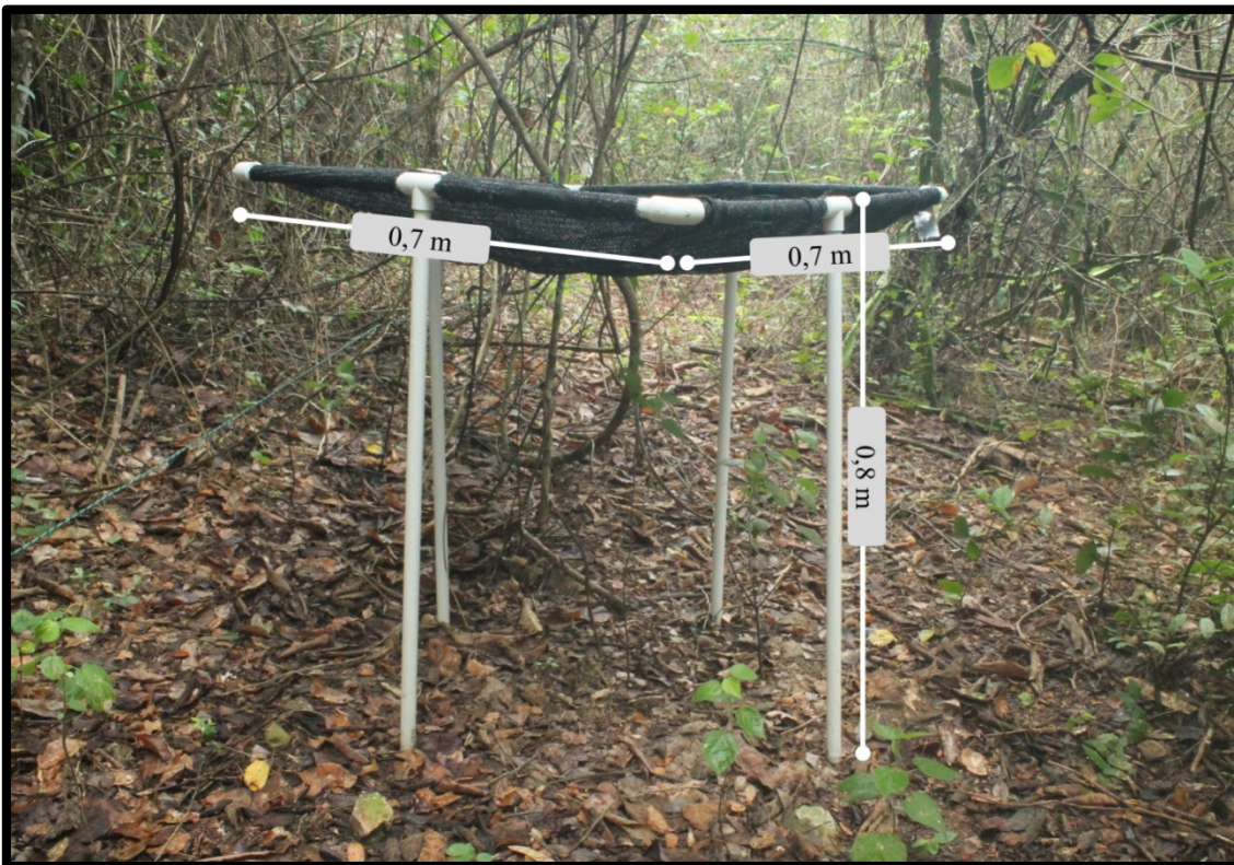
Fig. Anexa 4. Trampas de semillas utilizadas en el presente trabajo de grado y sus dimensiones.
