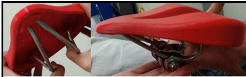
Ilustración 7. Base del sillín con rieles.
