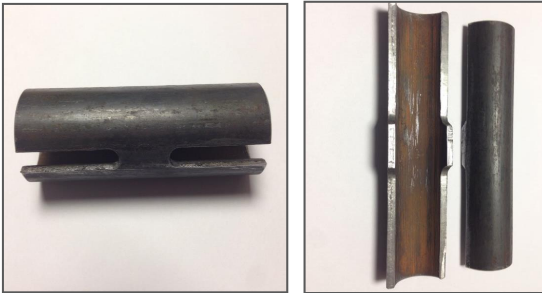
Figura 22. Mecanizado de tubo de refuerzo realizado
