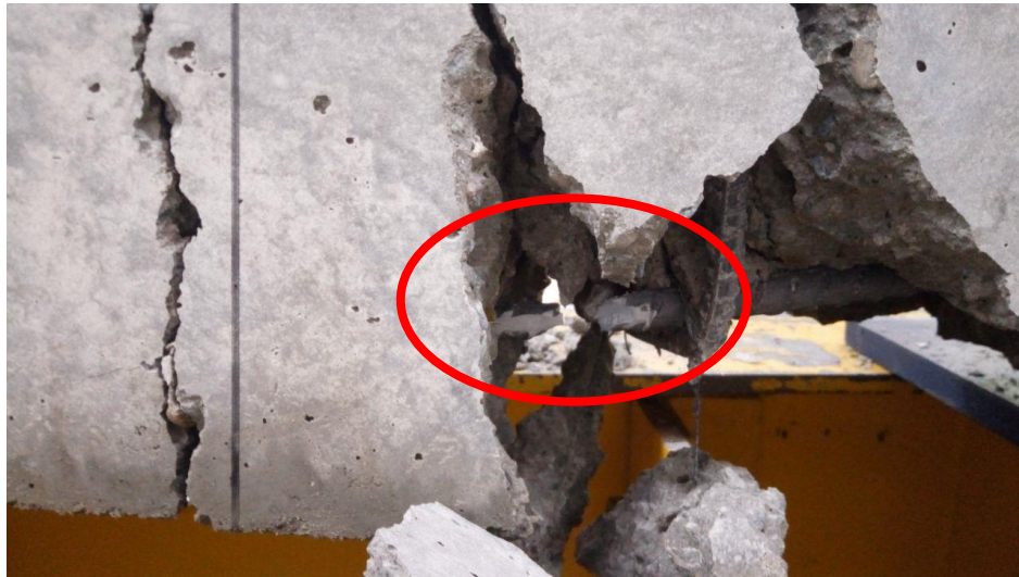
Figura 43. Finalización ensayo de flexión en vigas.
