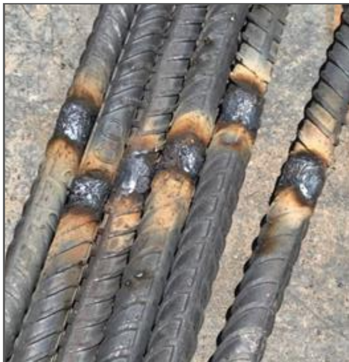
Figura 25. Soldadura realizada en las probetas de acuerdo con la NTC4040
