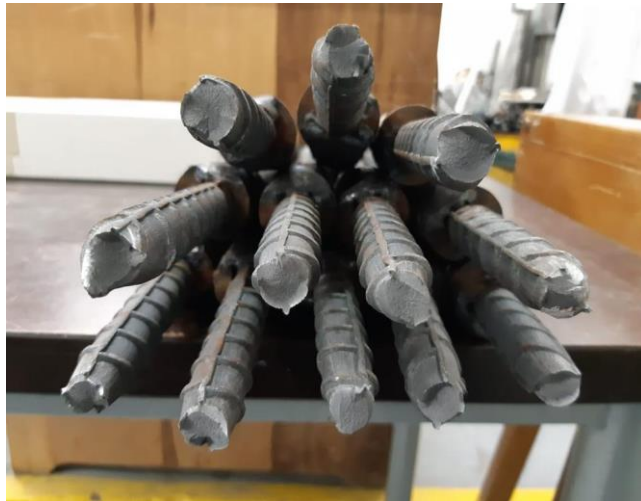
Figura 46. Patología de falla en probetas.
