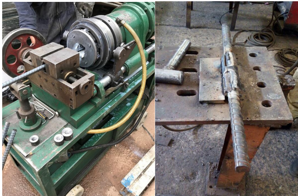
Figura 26. Unión barras de refuerzo con camisa perimetral
