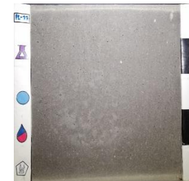
Superplastificante: SP1 Curado: film plástico (PF) Desmoldante: Base aceite vegetal (VO)
