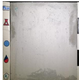
Superplastificante: SP2 Curado: Agua (WC) Desmoldante: Base aceite vegetal (VO)
