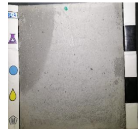
Superplastificante: SP1 Curado: film plástico (PF) Desmoldante: Base aceite mineral (MO)
