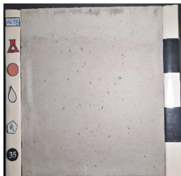
Superplastificante: SP2 Curado: Agua (WC) Desmoldante: sin desmoldante (SD)
