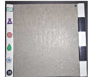
Superplastificante: SP1 Curado: Con tela quirúrgica (QC) Desmoldante: Petrodisel (D)
