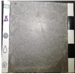
Superplastificante: SP1 Curado: film plástico (PF) Desmoldante: sin desmoldante (SD)
