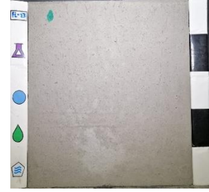
Superplastificante: SP1 Curado: Sin curado (SC) Desmoldante: Petrodisel (D)
