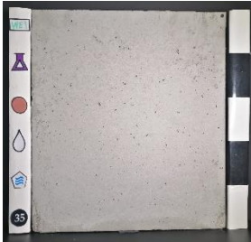
Superplastificante: SP1 Curado: Sin curado (SC) Desmoldante: sin desmoldante (SD)
