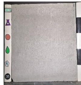
Superplastificante: SP1 Curado: Agua (WC) Desmoldante: Petrodisel (D)
