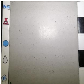
Superplastificante: SP2 Curado: Sin curado (SC) Desmoldante: sin desmoldante (SD)
