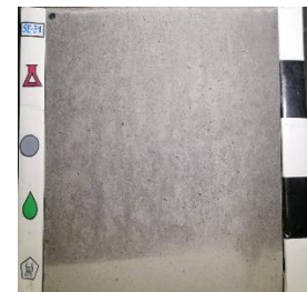
Superplastificante: SP2 Curado: film plástico (PF) Desmoldante: Petrodisel (D)
