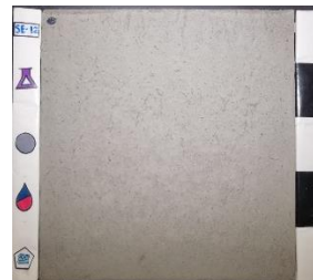
Superplastificante: SP1 Curado: Con tela quirúrgica (QC) Desmoldante: Base aceite vegetal (VO)
