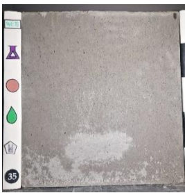
Superplastificante: SP1 Curado: film plástico (PF) Desmoldante: Petrodisel (D)
