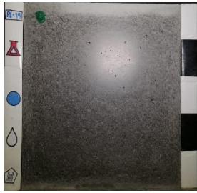
Superplastificante: SP2 Curado: film plástico (PF) Desmoldante: sin desmoldante (SD)
