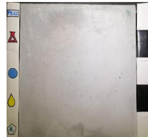
Superplastificante: SP2 Curado: Agua (WC) Desmoldante: Base aceite mineral (MO)
