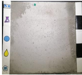
Superplastificante: SP1 Curado: Con tela quirúrgica (QC) Desmoldante: Base aceite mineral (MO)
