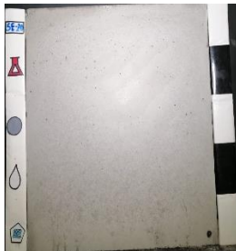
Superplastificante: SP2 Curado: Con tela quirúrgica (QC) Desmoldante: sin desmoldante (SD)
