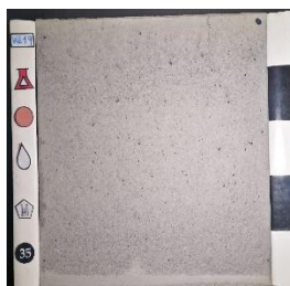
Superplastificante: SP2 Curado: Agua (WC) Desmoldante: sin desmoldante (SD)
