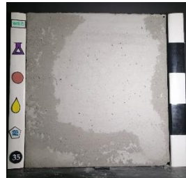
Superplastificante: SP1 Curado: Con tela quirúrgica (QC) Desmoldante: Base aceite mineral (MO)
