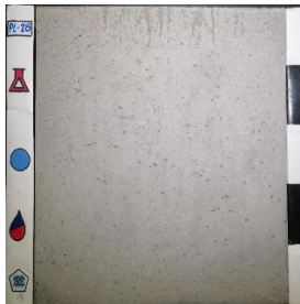
Superplastificante: SP2 Curado: Con tela quirúrgica (QC) Desmoldante: Base aceite vegetal (VO)
