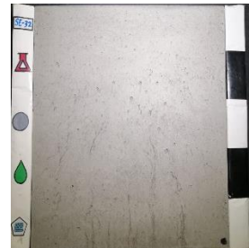
Superplastificante: SP12 Curado: Con tela quirúrgica (QC) Desmoldante: Petrodisel (D)
