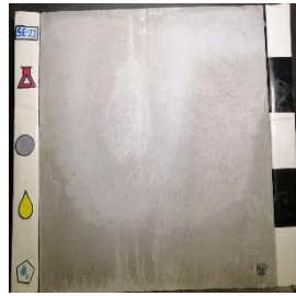
Superplastificante: SP2 Curado: Agua (WC) Desmoldante: Base aceite mineral (MO)
