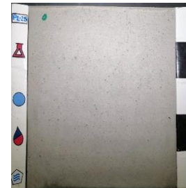
Superplastificante: SP2 Curado: Sin curado (SC) Desmoldante: Base aceite vegetal (VO)
