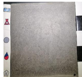
Superplastificante: SP2 Curado: film plástico (PF) Desmoldante: Base aceite vegetal (VO)
