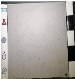
Superplastificante: SP2 Curado: Sin curado (SC) Desmoldante: sin desmoldante (SD)
