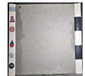
Superplastificante: SP2 Curado: Agua (WC) Desmoldante: Base aceite vegetal (VO)
