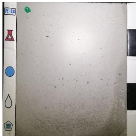
Superplastificante: SP2 Curado: Con tela quirúrgica (QC) Desmoldante: sin desmoldante (SD)
