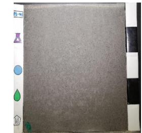
Superplastificante: SP1 Curado: film plástico (PF) Desmoldante: Petrodisel (D)
