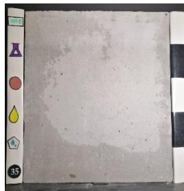
Superplastificante: SP1 Curado: Agua (WC) Desmoldante: Base aceite mineral (MO)
