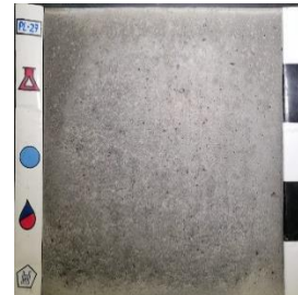
Superplastificante: SP2 Curado: film plástico (PF) Desmoldante: Base aceite vegetal (VO)
