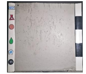
Superplastificante: SP2 Curado: Sin curado (SC) Desmoldante: Petrodisel (D)
