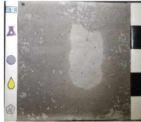
Superplastificante: SP1 Curado: film plástico (PF) Desmoldante: Base aceite mineral (MO)
