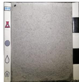
Superplastificante: SP2 Curado: film plástico (PF) Desmoldante: sin desmoldante (SD)
