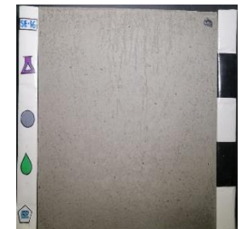
Superplastificante: SP1 Curado: Con tela quirúrgica (QC) Desmoldante: Petrodisel (D)
