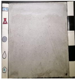
Superplastificante: SP2 Curado: Agua (WC) Desmoldante: sin desmoldante (SD)
