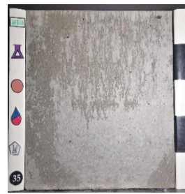
Superplastificante: SP1 Curado: film plástico (PF) Desmoldante: Base aceite vegetal (VO)
