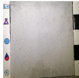
Superplastificante: SP1 Curado: Agua (WC) Desmoldante: Base aceite vegetal (VO)
