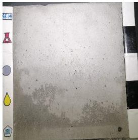
Superplastificante: SP2 Curado: Con tela quirúrgica (QC) Desmoldante: Base aceite mineral (MO)
