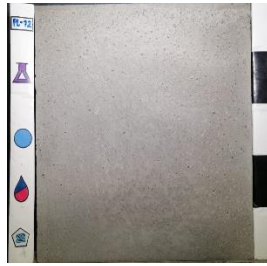
Superplastificante: SP1 Curado: Con tela quirúrgica (QC) Desmoldante: Base aceite vegetal (VO)
