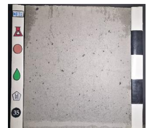
Superplastificante: SP2 Curado: Agua (WC) Desmoldante: Petrodisel (D)
