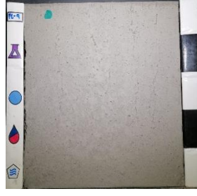
Superplastificante: SP1 Curado: Sin curado (SC) Desmoldante: Base aceite vegetal (VO)
