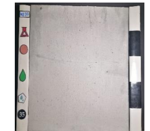
Superplastificante: SP2 Curado: Agua (WC) Desmoldante: Petrodisel (D)
