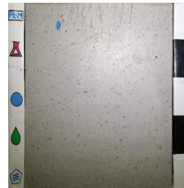
Superplastificante: SP2 Curado: Sin curado (SC) Desmoldante: Petrodisel (D)
