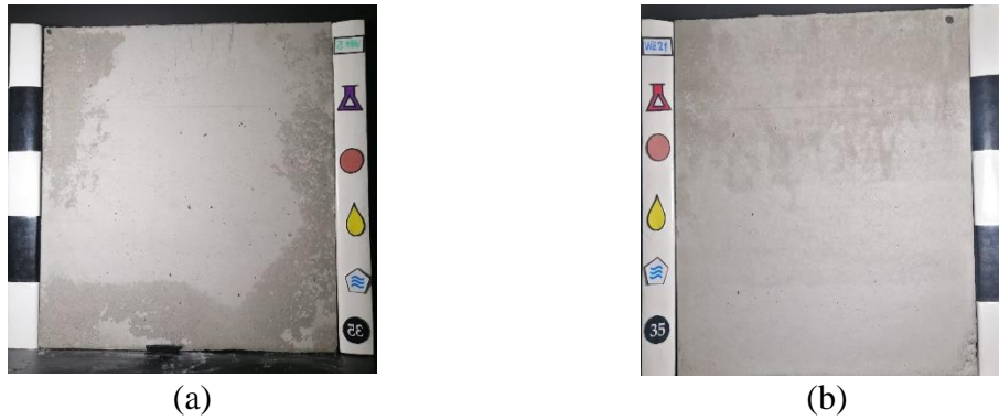
Figura 12 Formaleta PP – Desmoldante MO – Curado SC; a) Superplastificante SP1 (CSC2), b) Superplastificante SP2 (CSC3)
