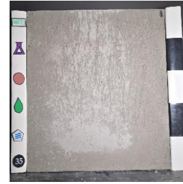
Superplastificante: SP1 Curado: Sin curado (SC) Desmoldante: Petrodisel (D)
