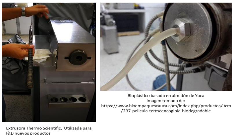
Figura 6. Equipo utilizado para extrusión de biopolímero con almidón de Yuca – Grupo Cytbia – Colombia Fuente: https://www.bioempaquescauca.com/index.php/productos/item/237-pelicula-termoencogible-biodegradable
