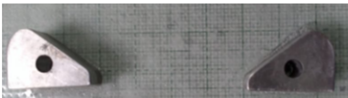
Figura 6-15.: Par de Electrodos de extracción fabricados en aluminio
