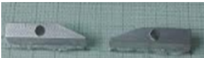
Figura 6-14.: Par de Electrodos Plasma fabricados en aluminio
