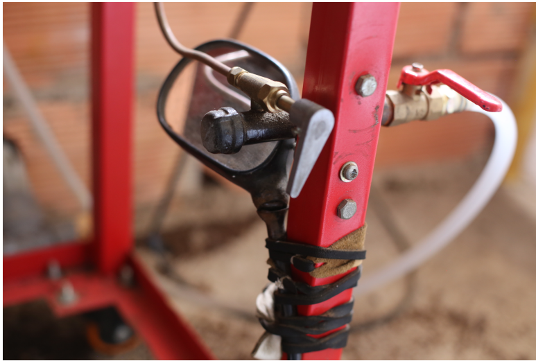
Imagen 10 . Adecuación de espejo retrovisor de moto a tostadora JL. Asociación De Finca . (Vereda Guavio Alto. 8 de octubre de 2018).
