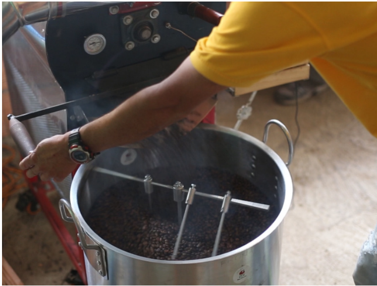
Imagen 11. Aspas implementadas para el enfriamiento del café tostado. Asociación De Finca . (Vereda Guavio Alto. 8 de octubre de 2018).
