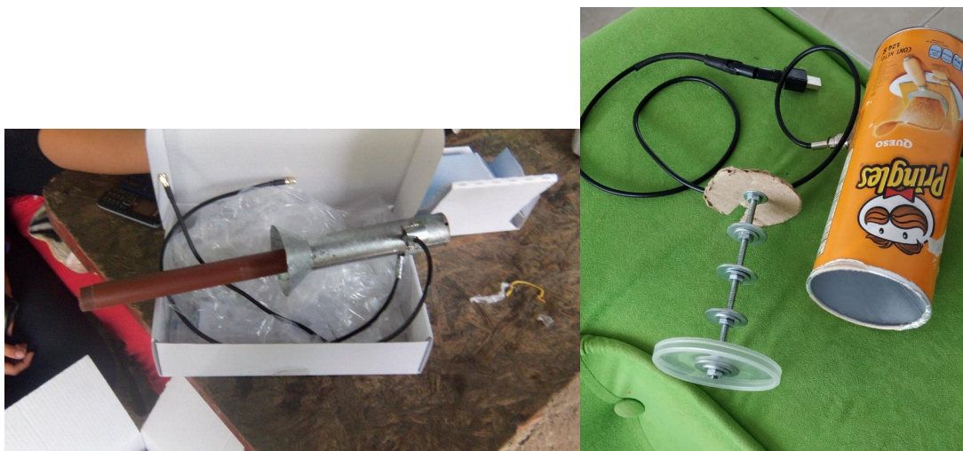
Imagen 12. Antenas WiFi desarrolladas por Red FusaLibre con tubos PVC, láminas de metal dobladas y empaques de alimentos reciclados. (Fusagasugá: 2019)
