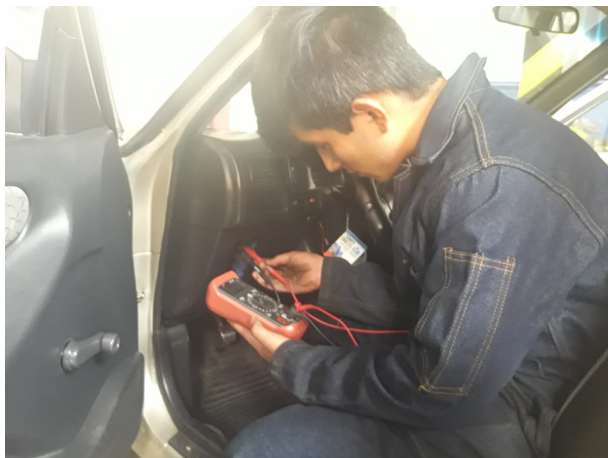
Figura 5. Medición de continuidad en el fusible de la bomba de combustible Fuente: Autores
