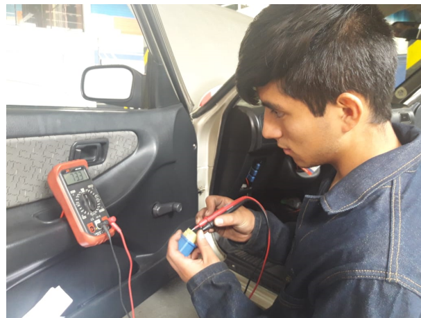
Figura 7. Comprobación del relé de la bomba de combustible Fuente: Autores
