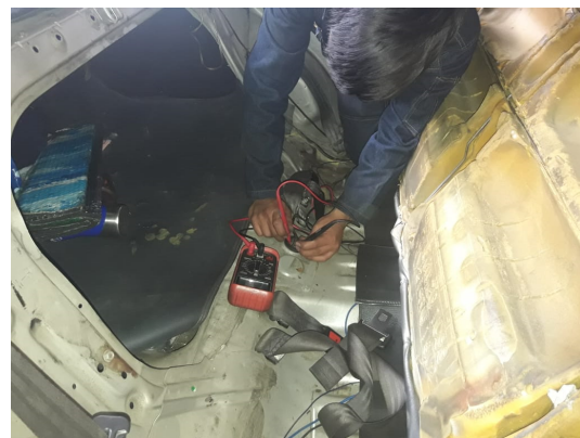
Figura 4. Verificación de 12 voltios en el conector de la bomba de combustible Fuente: Autores
