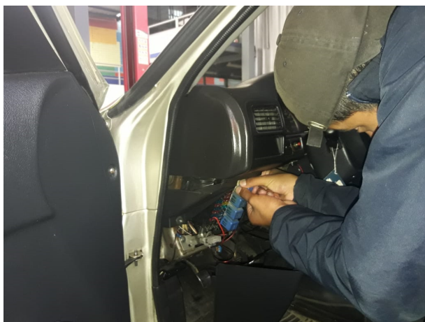
Figura 6. Extracción del relé de la bomba de combustible Fuente: Autores
