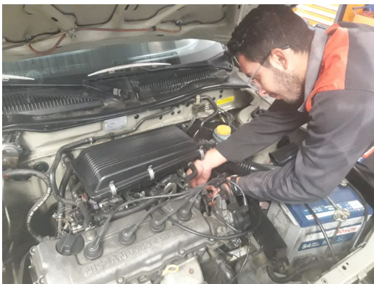
Figura 2. Comprobación de combustible en la llegada y retorno del riel de inyectores Fuente: Autores.
