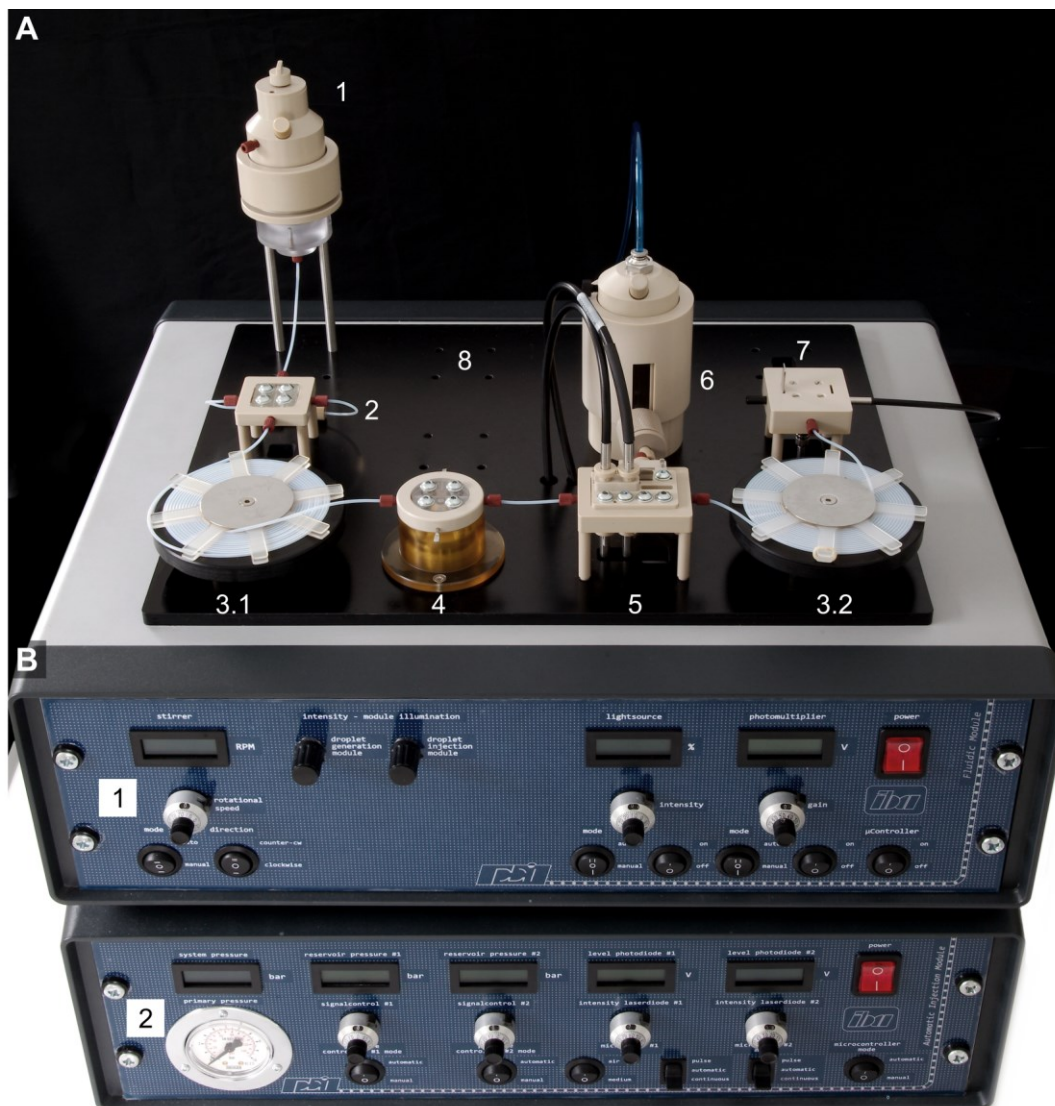
Abb. 3.2: Photographie der tropfenbasierten mikrofluidischen Plattform; A – Fluidische Einheit, 1: Mischmodul, 2: Tropfenmodul, 3.1 und 3.2: Speichermodul, 4: Druckmodul, 5: Zudosiermodul, 6: Vorlagereservoir, 7: Spektroskopiemodul; B – Kontrolleinheit, 1: 1. Untereinheit, 2: 2. Untereinheit.
