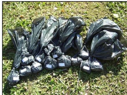
**Figura 4.6** – Armazenamento e identificação *in loco* das amostras de solos recolhidas.
