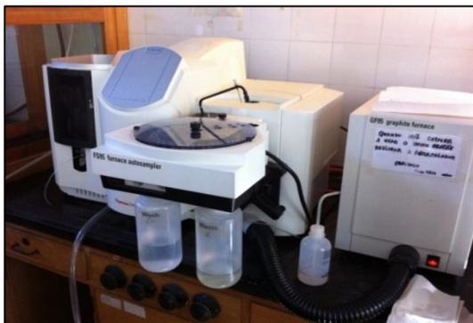
**Figura 4.15** – Espectrómetro de Absorção Atómica com Forno de Grafite (GFAAS).
