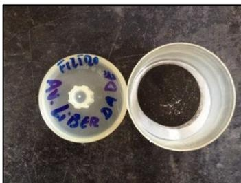
**Figura 4.35** – Filtro depois de utilizado na filtração da água da chuva recolhida na da Av. Liberdade.
