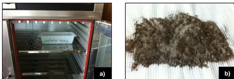
Figura 4.7 – **a)** Processo de secagem do solo; **b)** Aspecto do solo depois do processo de secagem.
