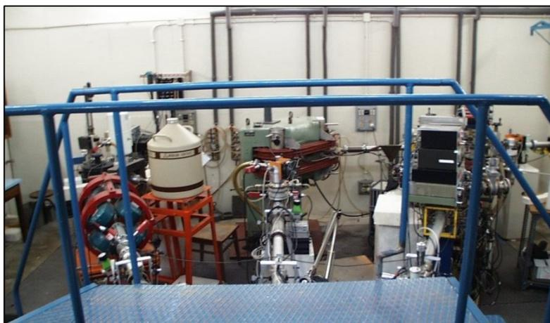
**Figura 4.32** – Acelerador de Van de Graaff de 2.5 MV, com três linhas experimentais que disponibiliza as técnicas de feixe de iões como o PIXE.
