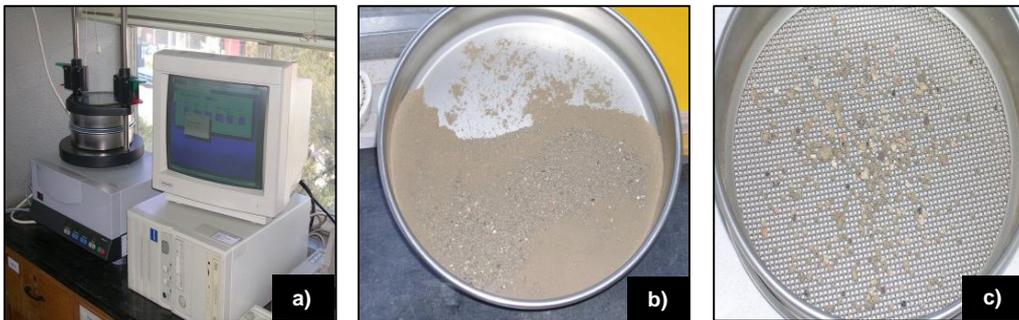
**Figura 4.9** – Etapas do processo de peneiração: **a)** Peneiração controlada por computador, **b)** Fracção de solo com granulometria < 2.00 mm, **c)** Fracção de solo com granulometria > 2.00 mm.
