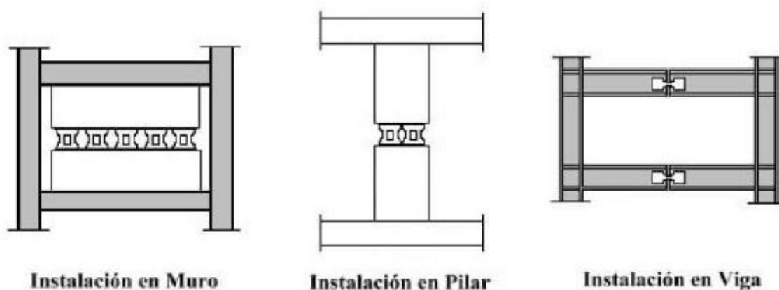
Figura 12 Ejemplos de instalación del amortiguador Honeycomb (Gatica, 2012)
