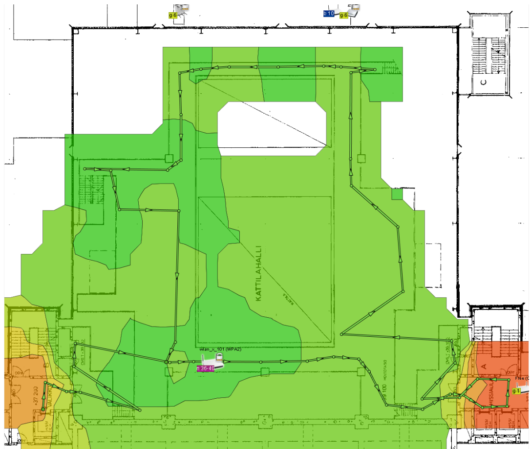
Liite 19, Kuva 33, Teollisuusluokan laite: Kattilahalli taso 11 (+37,20 m), 5GHz kuuluvuus
