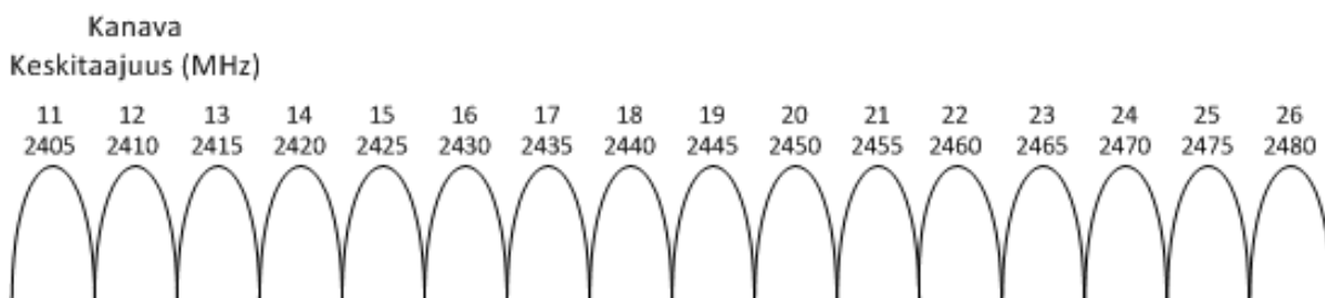
Kuva 2, IEEE 802.15.4 kanavajako, 2,4GHz taajuusalueella
