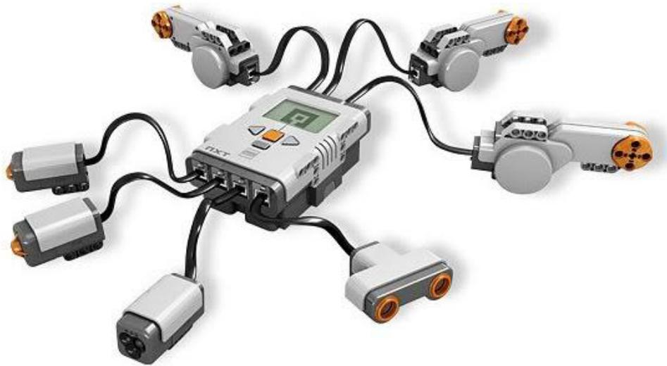
Figura 7 – *Kit Legó NXT*, com controlador, sensores e motores
