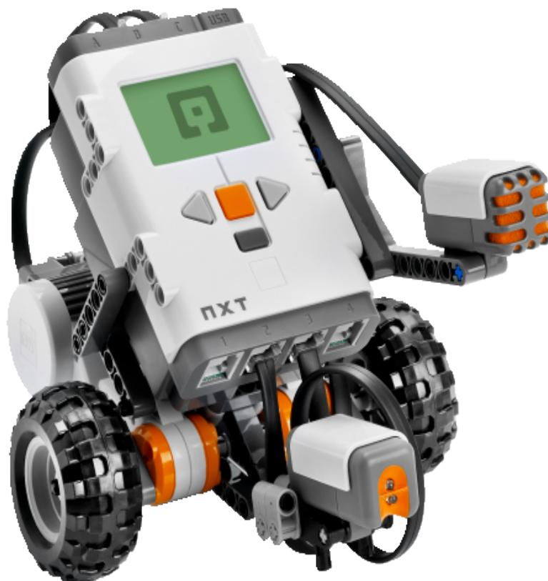
Figura 9 – Exemplo de um robô montado com um kit Lego NXT
