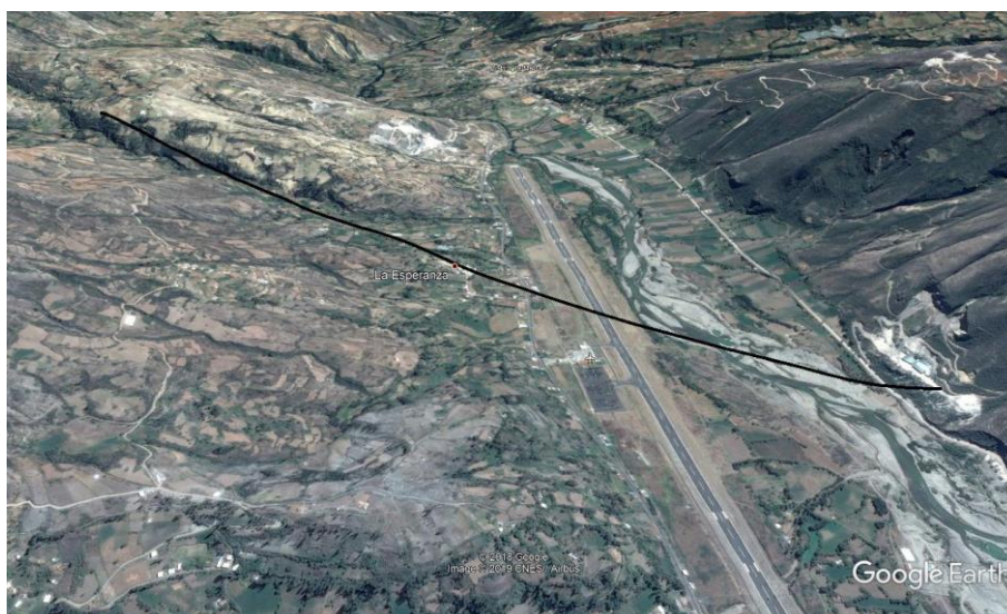
Figura 35 Transepto A – A': Norte del aeropuerto de Anta. Distancia 3.05 km. Pendiente máxima 39.7%, pendiente media 7.9 – 12.3% Fuente. Google Earth Pro.
