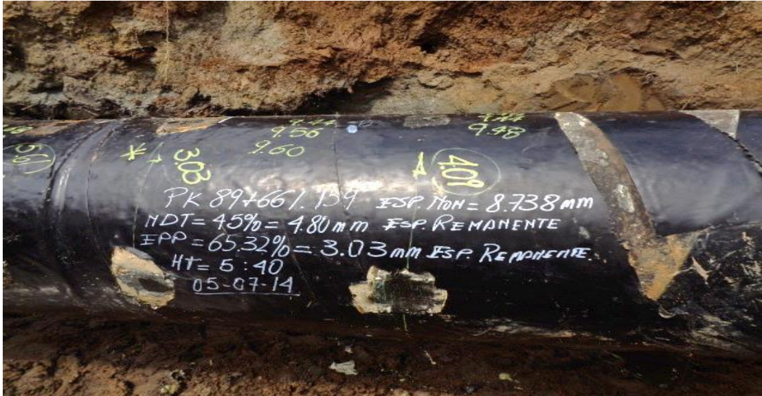
Foto 2.2 Muestra Probeta de rotura y fuga de hidrocarburos Fuente: Investigador
