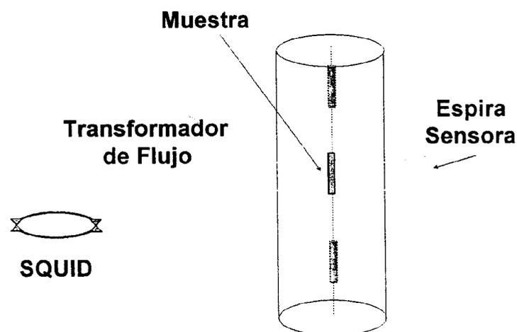
**Figura 8.2:** Esquema de un magnetómetro usando un dispositivo SQUID.
