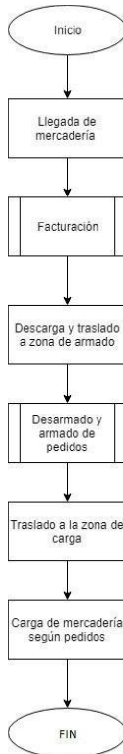
Figura 3. 9 Flujograma de operación recepción-despacho
