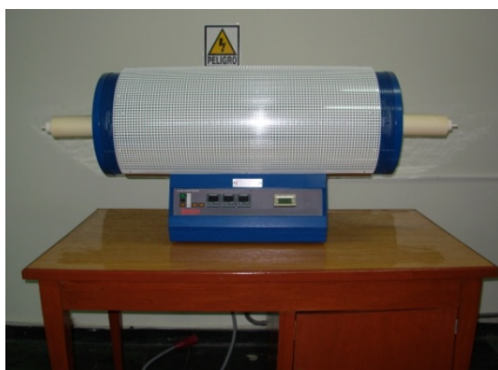
Fig. 3.5 Obtención de la muestra en polvo al realizar el calentamiento en una estufa o en el horno tubular LENTON.
