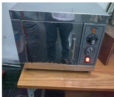
Fig. 3.5 Obtención de la muestra en polvo al realizar el calentamiento en una estufa o en el horno tubular LENTON.
