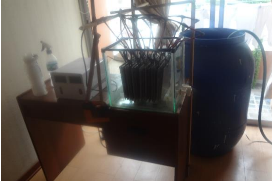
Figura 20. Celda de electrocoagulación terminada, lista para su utilización. Elaboración del Tesista
