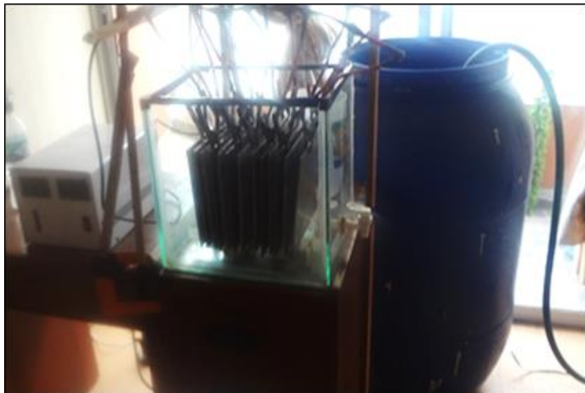
Figura 12. Equipo Instalado para el tratamiento de electrocoagulación. Elaboración por el tesista.
