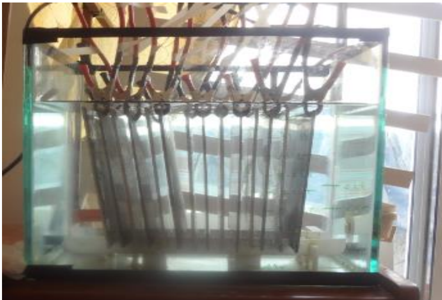
Figura 17. Celda de electrocoagulación a una distancia de 1cm entre los electrodos. Elaboración del Tesista
