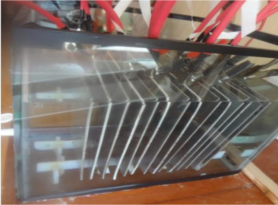
Figura 18. Celda de electrocoagulación a una distancia de 1.5 cm entre los electrodos. Elaboración del Tesista
