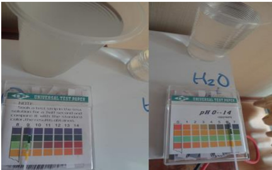
Figura 16. Medición el pH de las muestras. Elaboración del tesista
