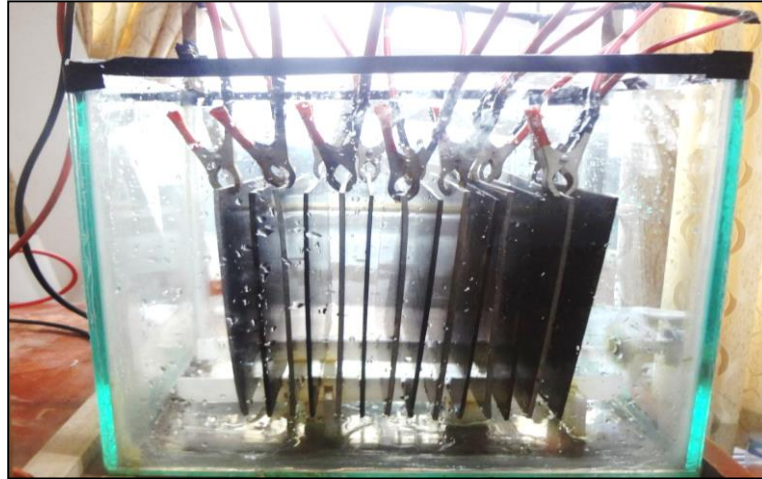
Figura 11. La instalación de los electrodos de aluminio y acero inoxidable de una celda de electrocoagulación. Fuente. Elaboración por el tesista.
