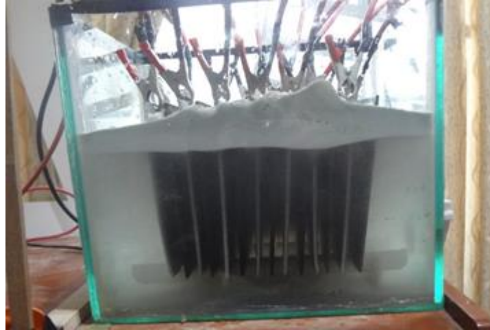
Figura 5. Proceso de Electrocoagulación. Fuente: Elaboración del tesista.
