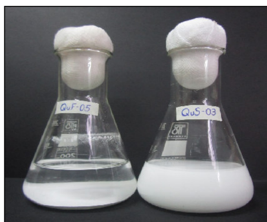
Figura 14. Cultivos de CMLP en medio mínimo suplementado con sulfuro de zinc a 5°C en reposo (izquierda) y agitación (derecha).
