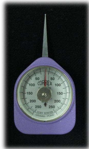
Dinamómetro usado para la medición de la magnitud de las fuerzas
