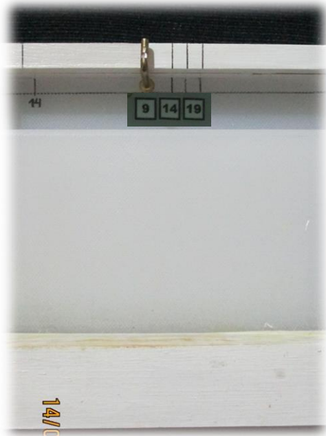
Maqueta usada para estirar los elásticos tres veces su diámetro interno
