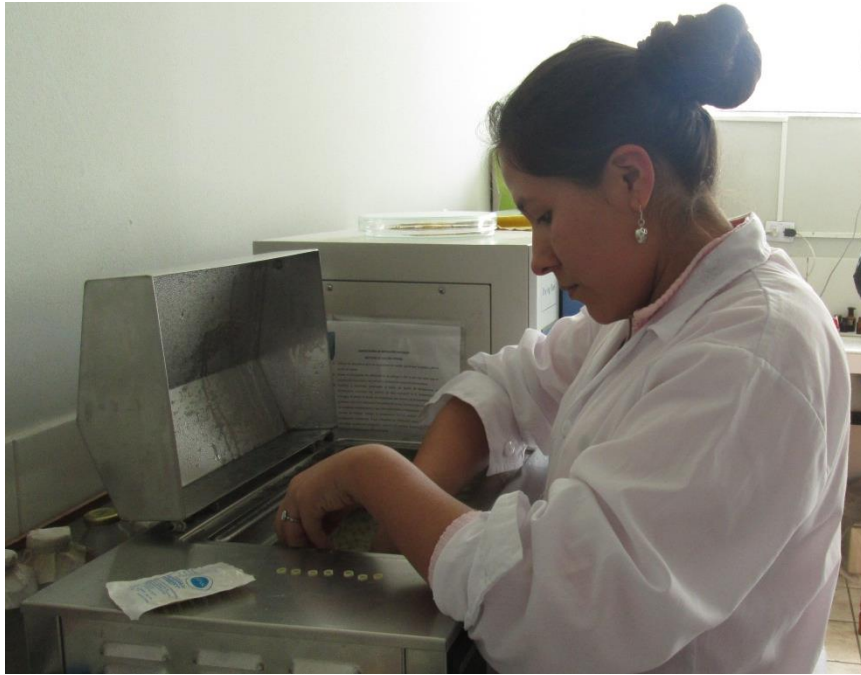
Colocación de los elásticos en los pines los cuales están sumergidos en el agua.
