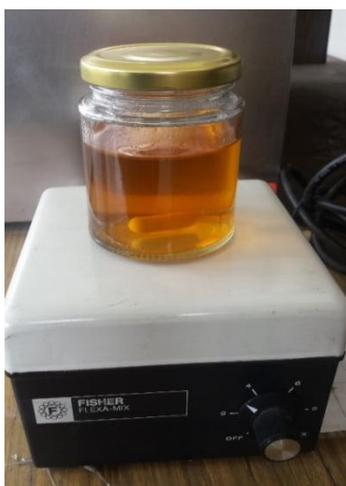
Fig.7 Dilución de quitosano en solución de ácido ascórbico (1%)
