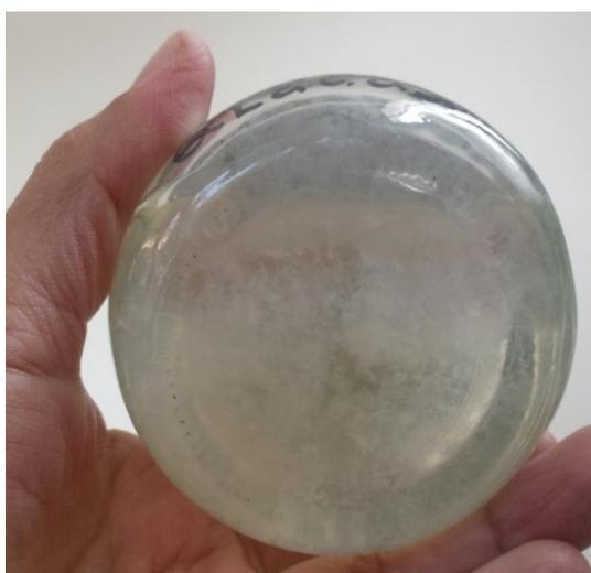
Fig. 13 Solución, producto de la decocción de piña con adición de quitosano al 0.01% (en ácido ascórbico 1%). Presencia de precipitados.
