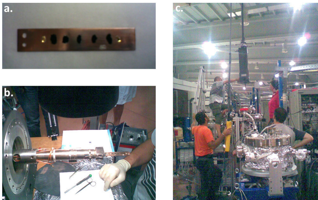
Figura 2.10: Montaje de las muestras superconductoras en el ramal SuperESCA del Síncrotrón Elettra de Trieste - Italia.
