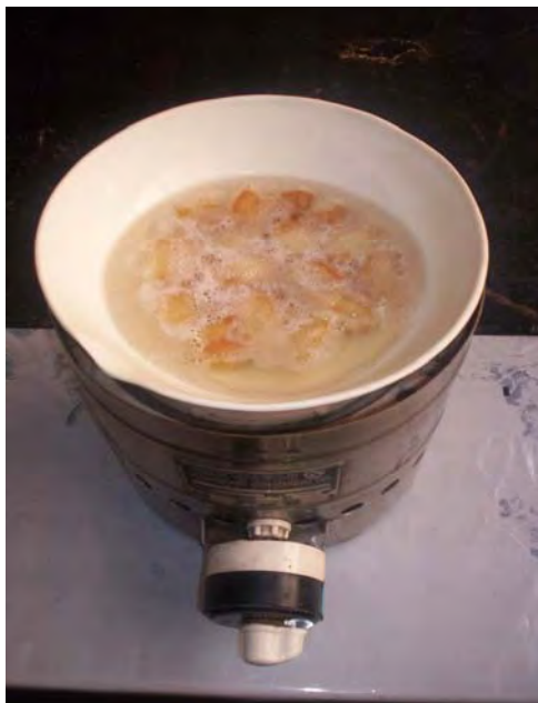
Figura N° 8: Extracción de la manteca por calentamiento directo
