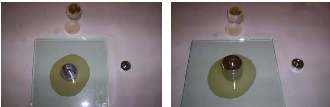
Figuras N° 27, 28 y 29: Prueba de extensibilidad por aplicación de peso
