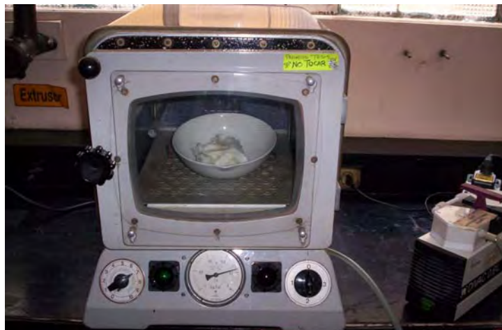
Figura N° 14: Estufa de vacío para el “secado” de la manteca
