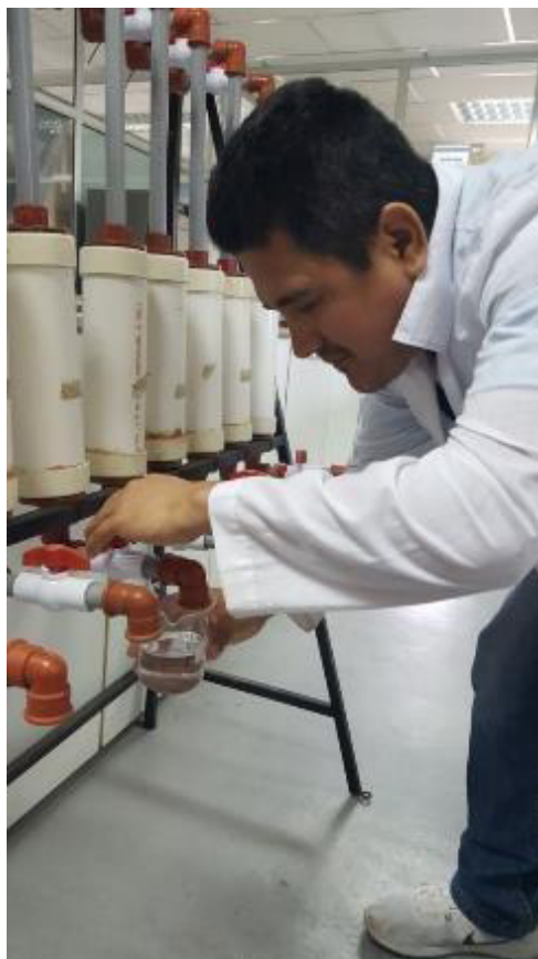
Foto 7. Muestreo al finalizar el filtrado
