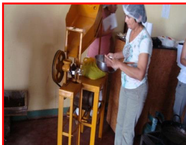
Fig. 11. Maquina moledora de granos de cacao para la obtención de pasta de cacao
