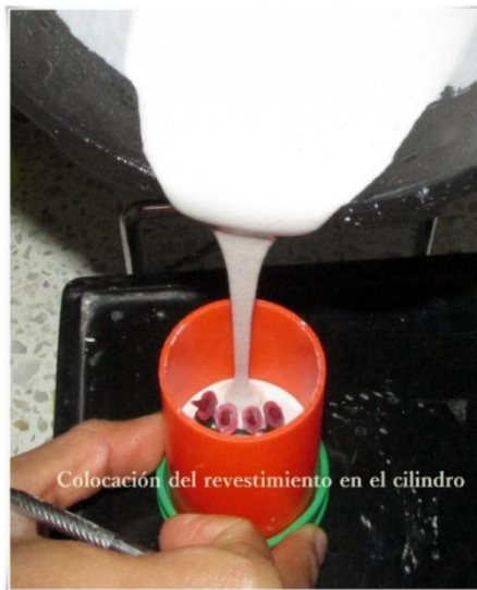
Figura 21: Vaciado del revestimiento
