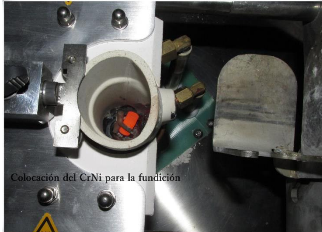
Figura 24: Colocación de la aleación de CrNi.
