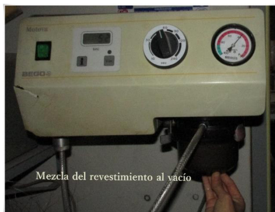
Figura 20: Mezcla del revestimiento al vacío
