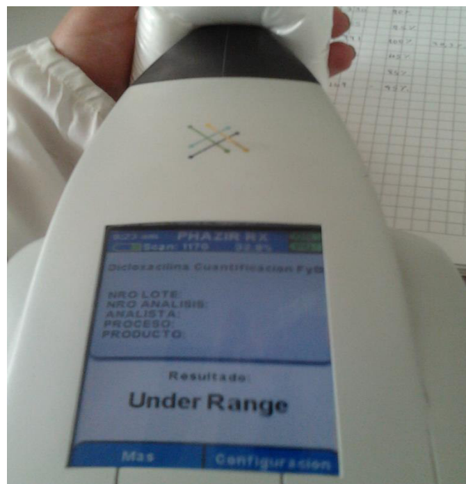
Fig. N°32: Escaneo en el equipo NIR de mezcla de excipientes.
