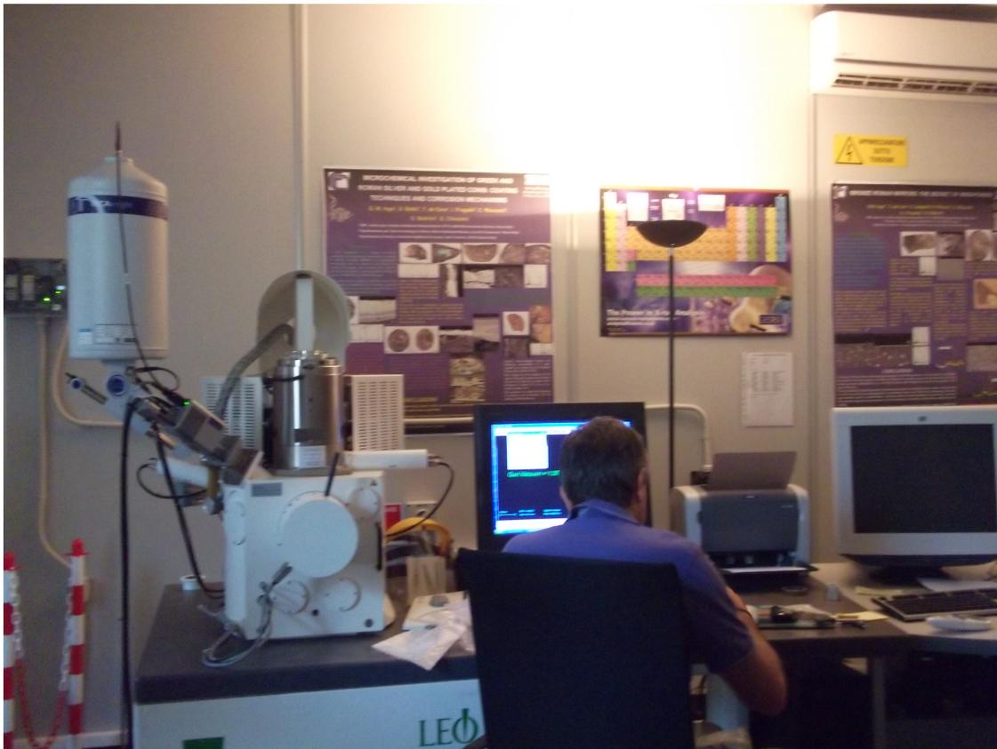
Figura 2.18: Fotografía del microscopio electrónico de barrido utilizado.
