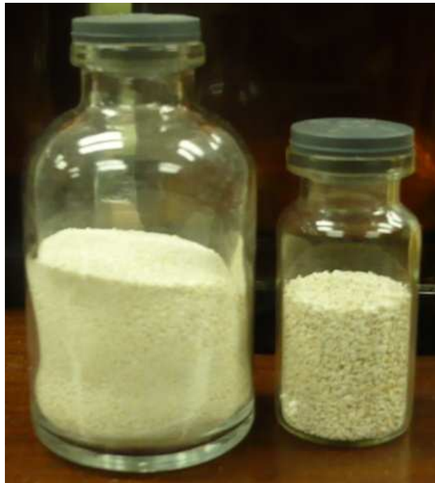
Fig. 14 Muestras de quitosano obtenido a partir del “cangrejo” Cancer setosus , después de la desacetilización
