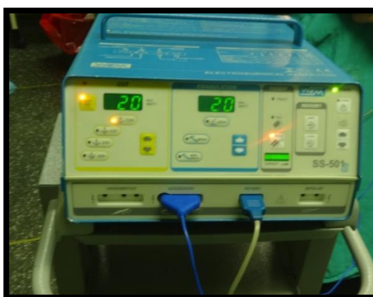
Fig. N°81 Equipo de electrocauterio de la marca WEM Modelo: SS501MCA, programado con 20 W de corte y coagulación, se empleara en modo monopolar para el procedimiento.
