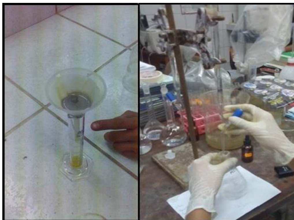
Foto 2: Toma de muestras y control de la concentración de cianuro libre
