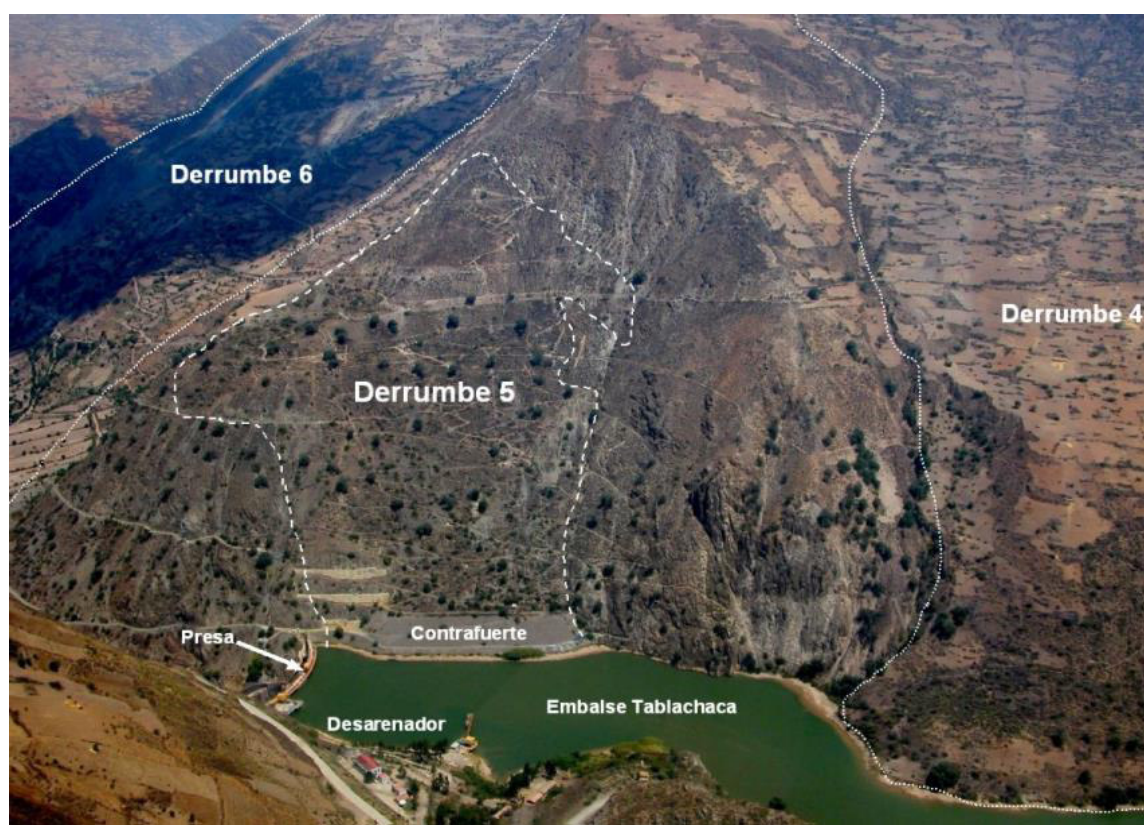
Figura 3.20. Modelo conceptual de recarga del Derrumbe 5.
