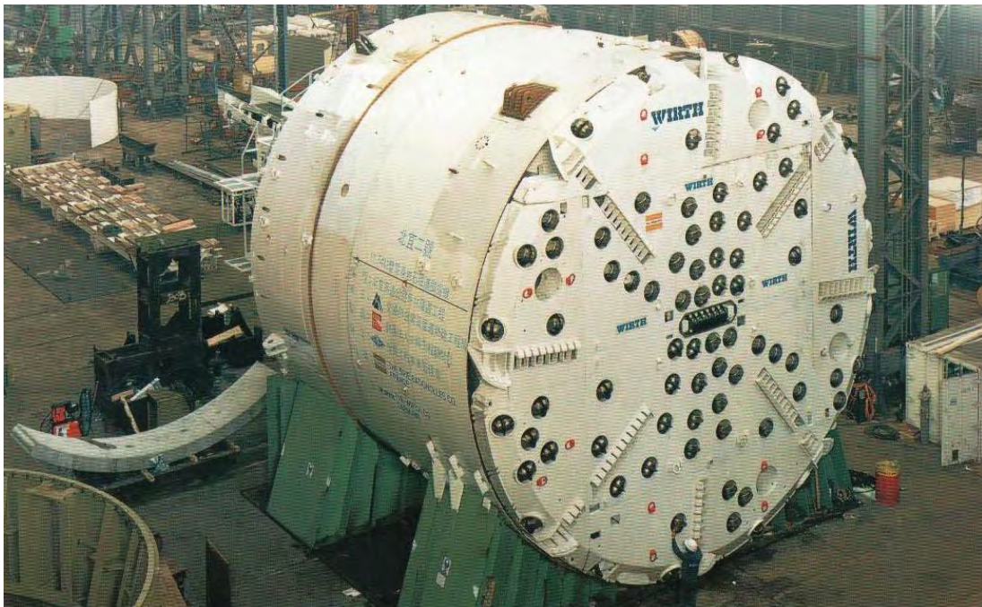
Fotografía N° 2-17: “TBM” Wirth de doble escudo “TB H1172 H/TS” en Pinglin - Taiwan.
