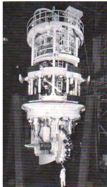
Fotografía N° 2-12: Shaft Boring de Robbins Co.
