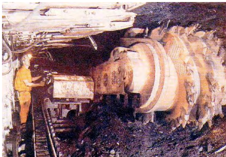
Fotografía N° 2-14: Rozadora Anderson AM500 cortando un manto de carbón en Inglaterra.
