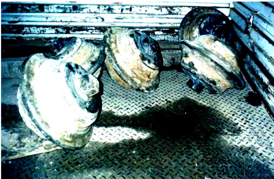
Fotografía N° 4-8: Los 5 primeros gauges cutters extraídos del cabezal de la “TBM MK 12”, para reemplazar los discos cortadores.
