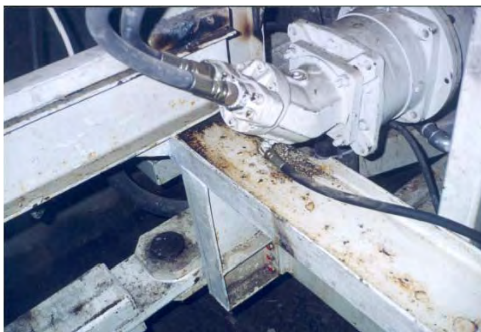
Fotografía 3-17: Impulsor hidráulico de rotación (jog) montado en la parte posterior del motor inferior izquierdo.
