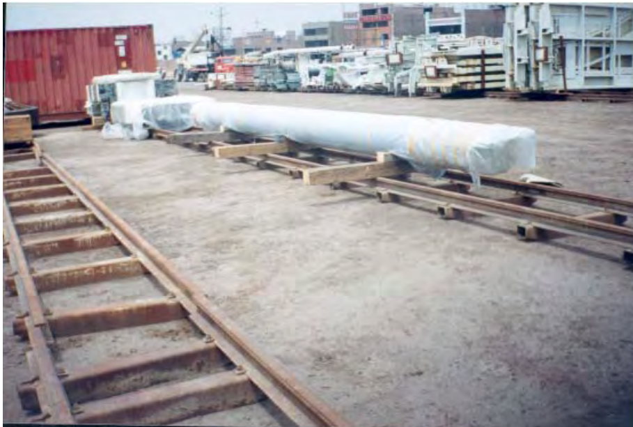
Fotografía N° 3-12: Eje de accionamiento del cabezal (eje de rotación).
