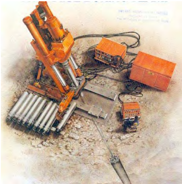
Fotografía N° 2-11: Raise Boring durante la excavación Robbins Co.
