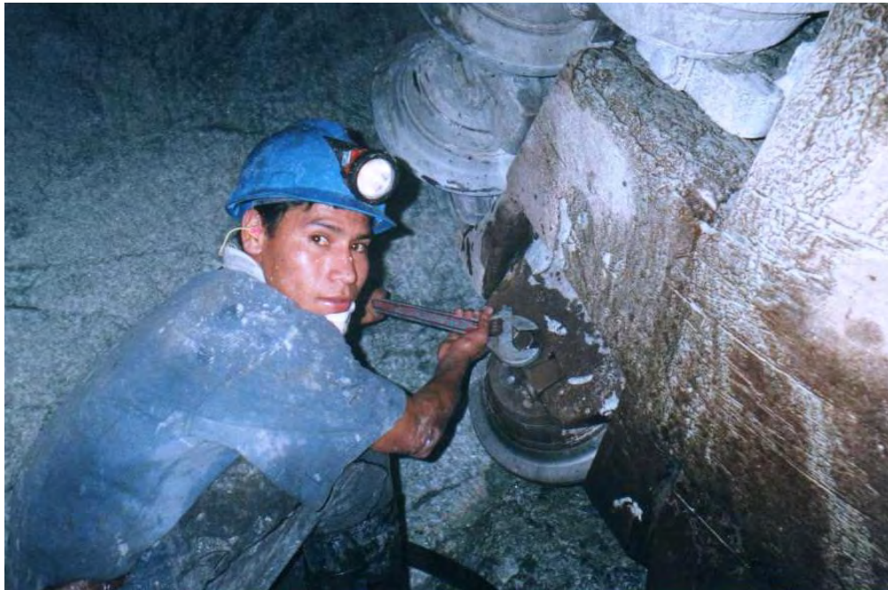
Fotografía N° 4-4: Mecánico de turno ajustando un gauge cutter cambiado.
