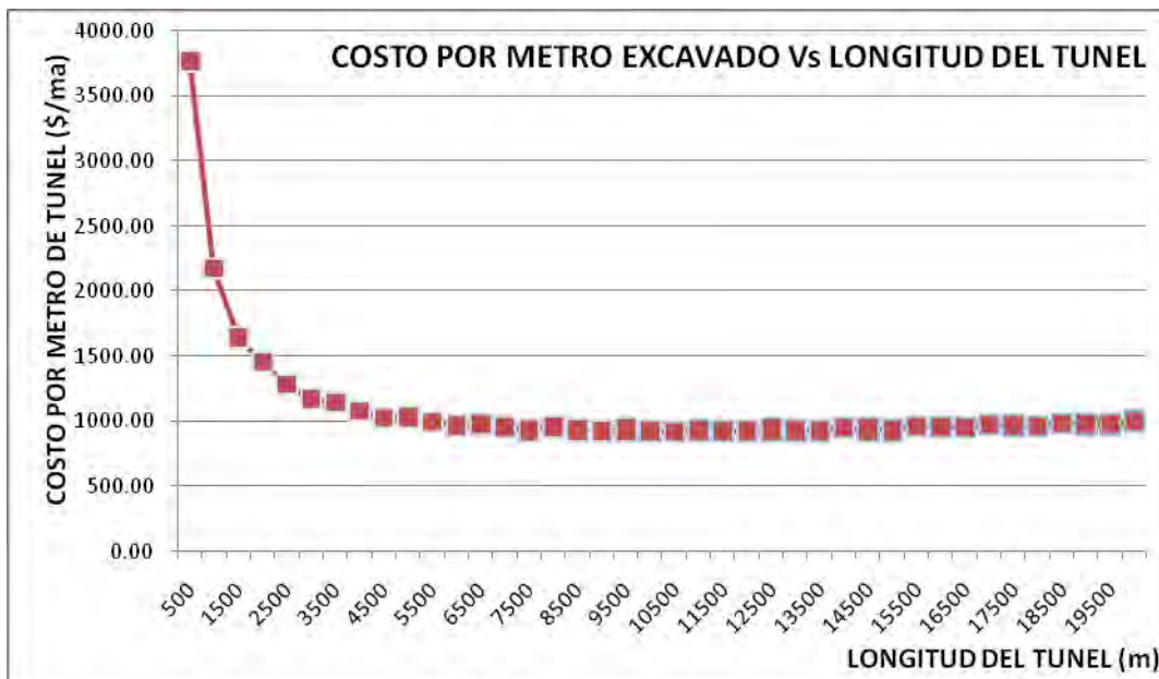
Gráfico N° 6-1: Costo equivalente por metro de excavación Vs longitud del túnel para “P&V”.
