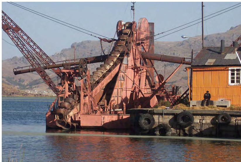
Fotografía N° 2-10: Draga con tolva continua en el puerto
