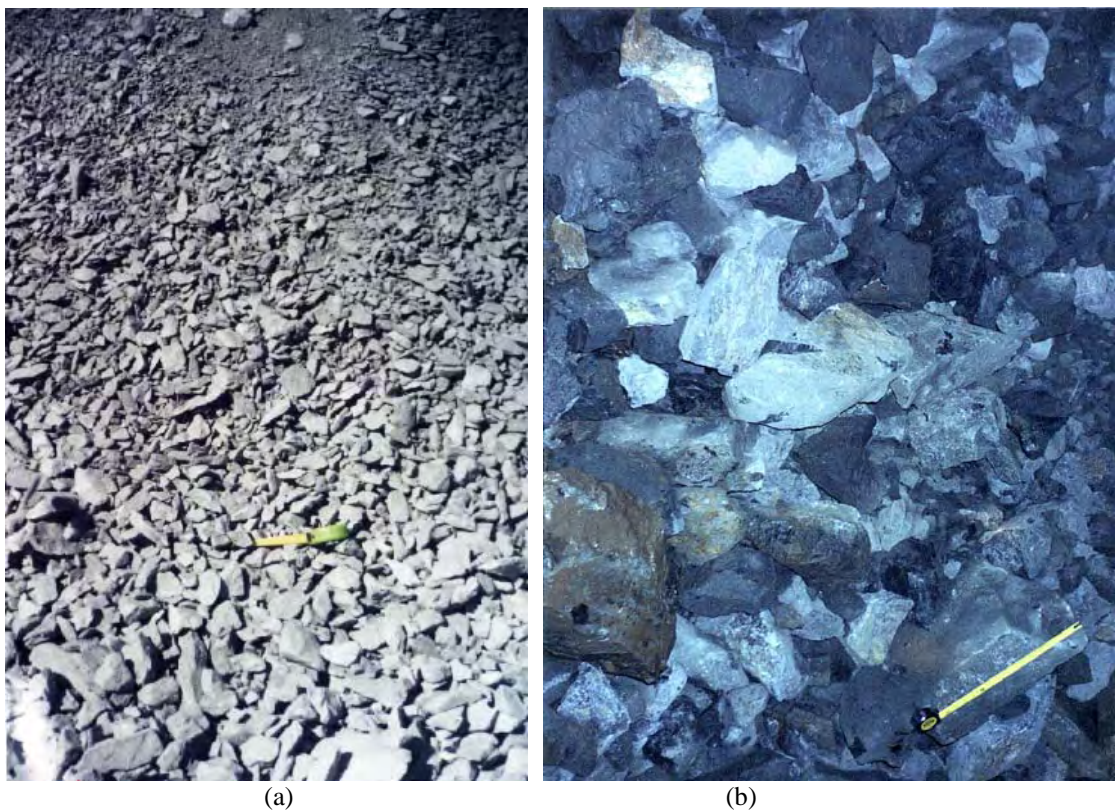
Fotografía N° 7-1: Granulometría del material fragmentado. (a) Con TBM. (b) con “P&V”.
