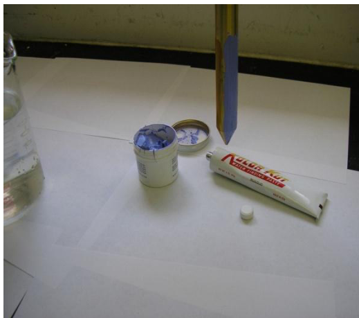
Fig. N° 42: Pasta indicadora cambia de color al contacto con el agua
