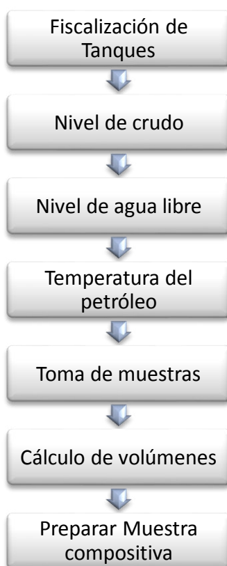
Fig. N° 50: Esquema del procedimiento de fiscalización de tanques
