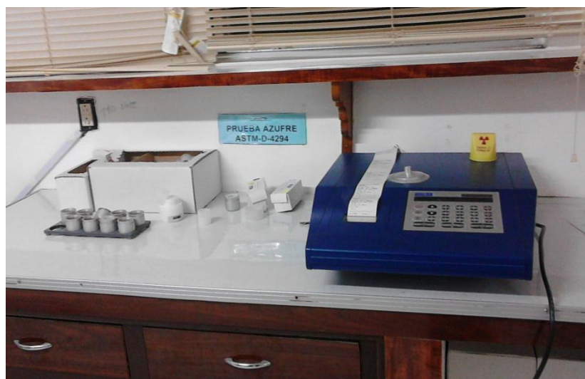
Fig. N° 59: Equipo para determinar el Azufre en crudo según ASTM D4294-10
