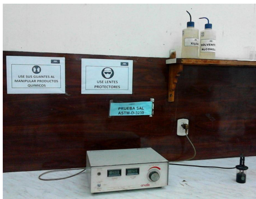
Fig. N° 65: Determinación de Sal en la muestra de petróleo crudo
