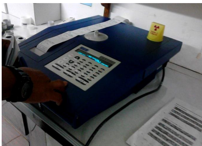
Fig. N° 66: Determinación de Azufre en la muestra de petróleo crudo
