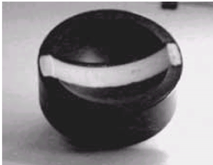
Figura B.3. Fotografía de un array cóncavo de 3.5 Mhz y 96 elementos. Aplicación: ecocardiografía tridimensional.
