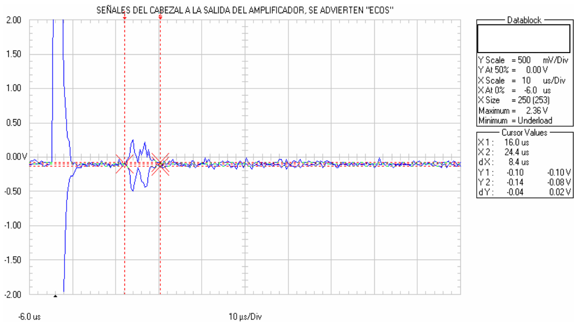
Figura 5.51. Respuesta del cristal, se advierten ECOS, con un retardo de 12 useg. del pulso de excitación. A escala 500 v/Dic y 10 usen /Div (observada en el osciloscopio).
