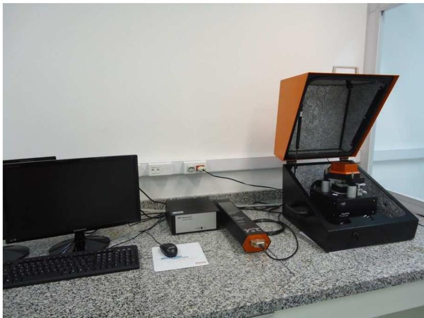
Figura 3.4: Equipo AFM Nanosurf Easyscan 2 con SPM control software Versión 3.1.
