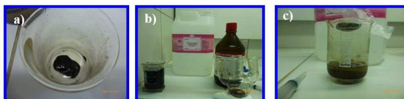
Figura 4.3: (a) NPM obtenidas inmediatamente después del tiempo de síntesis. (b) NPM suspendidas en etanol absoluto. (c) NPM son decantadas con ayuda de un imán en la base del becker para ser sometidas al proceso de lavado.
