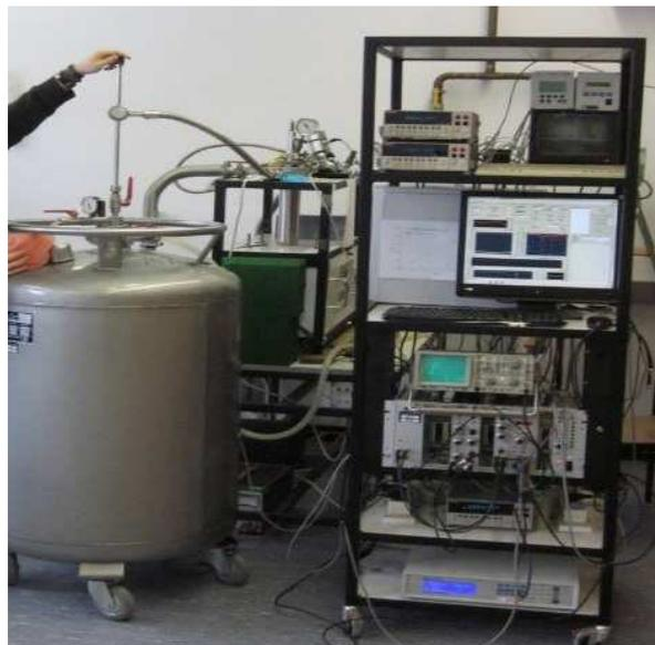
Figura 3.13: Espectrómetro Mössbauer utilizado.
