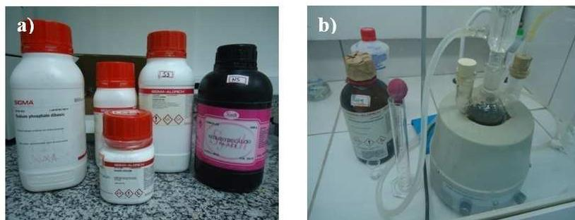
Figura 4.8: (a) Reactivos de grados analíticos utilizados en la preparación de las muestras (b) Preparación de las NPM utilizando el método de co-precipitación.
