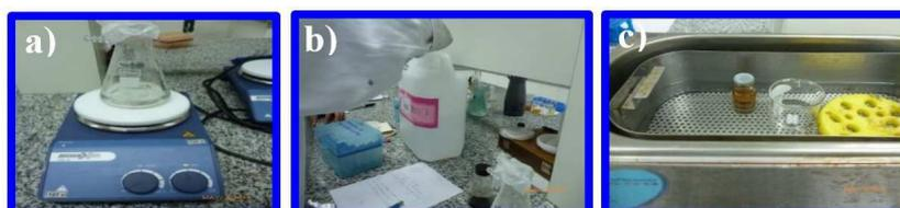
Figura 4.5: (a) Solución de CTAB. (b) Preparación de la solución de NPM con isopropanol y CTAB. (c) Sonicar por tres horas.
