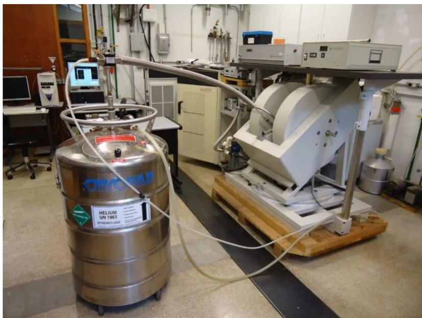
Figura 3.14: Equipo de Resonancia Paramagnética Electrónica.
