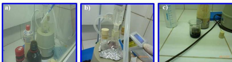
Figura 4.2: (a) Introducción de los agentes estabilizantes, Oleilamina y ácido oleico en la solución orgánica. (b) Control de temperatura en la síntesis con un termómetro digital. (c) solución final obtenida y suspendida en etanol absoluto.
