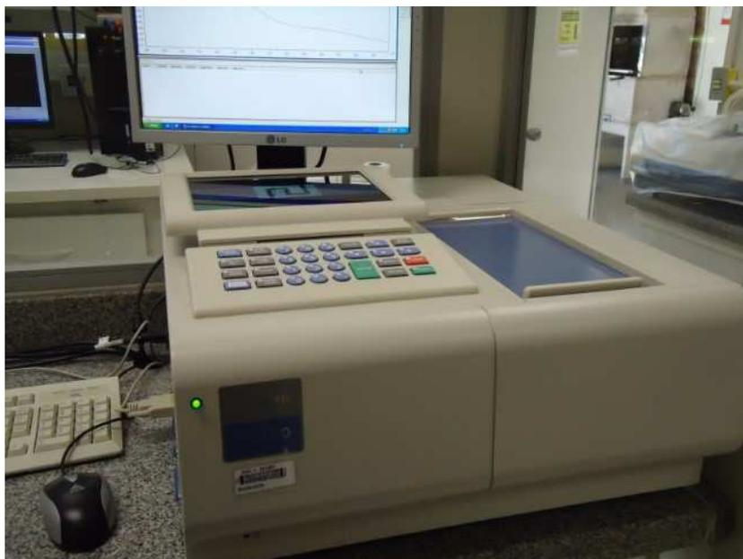
Figura 3.11: Espectrofotómetro Ultravioleta visible (UV-Vis) Hitachi U2000.
