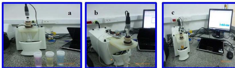
Figura 3.8: (a) Vista frontal del equipamiento con sus respectivas soluciones tampón (b) Proceso de lavado del electrodo con agua ultrapura y anteriormente almacenado en una suspensión de KCl (3M) con el objetivo de la conservación del mismo (c) Equipamiento listo y realizando las medidas de titulación.
