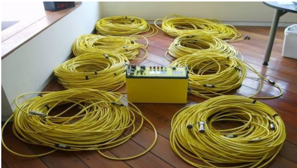
FOTO No. 13. Cableado del Equipo SuperSting R8 conformado por 8 secciones de 162.0 m de longitud con 7 sensores (electrodos de corriente) por sección, distanciados uno de otro 20.25 m.
