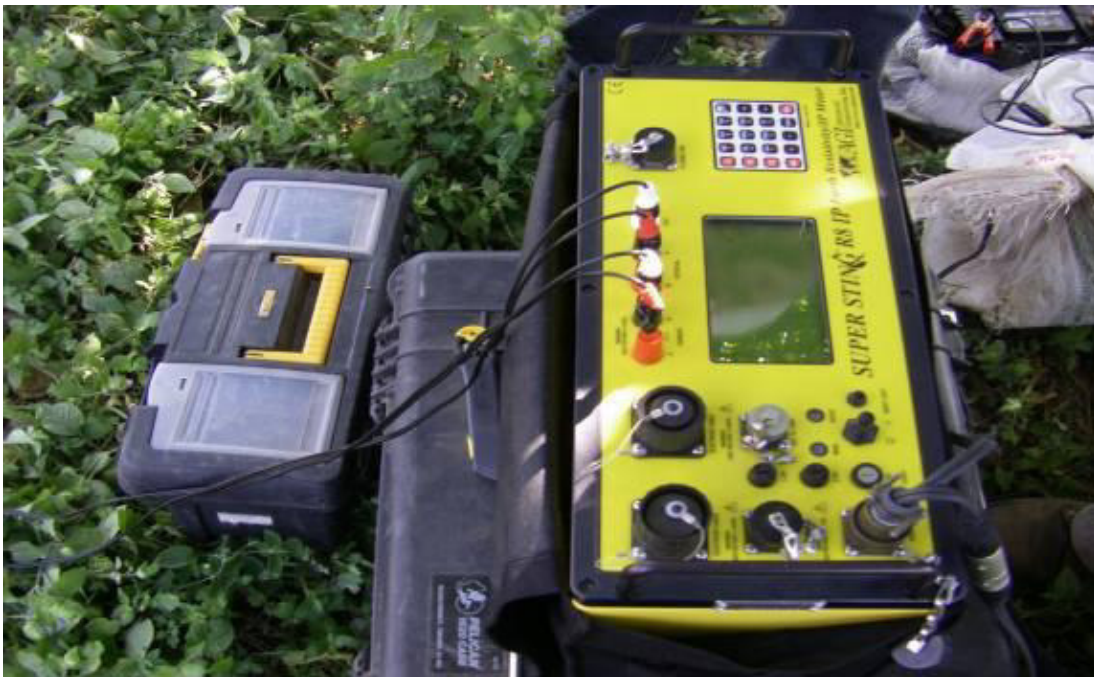
FOTO No. 12. Modulo del equipo SuperSting R8 de 8 canales y 200 watt de potencia empleado para el levantamiento de la Prospección Geoeléctrica Continua.
