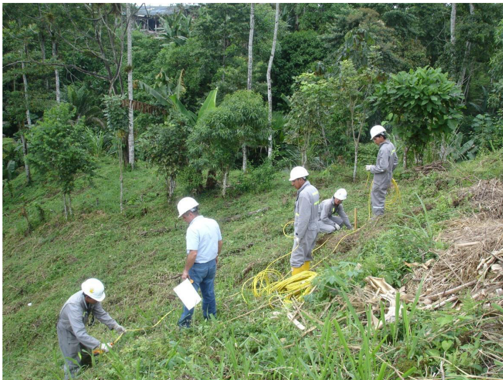
FOTO No. 1. Inicio de emplazamiento del perfil geoelectrico L2
