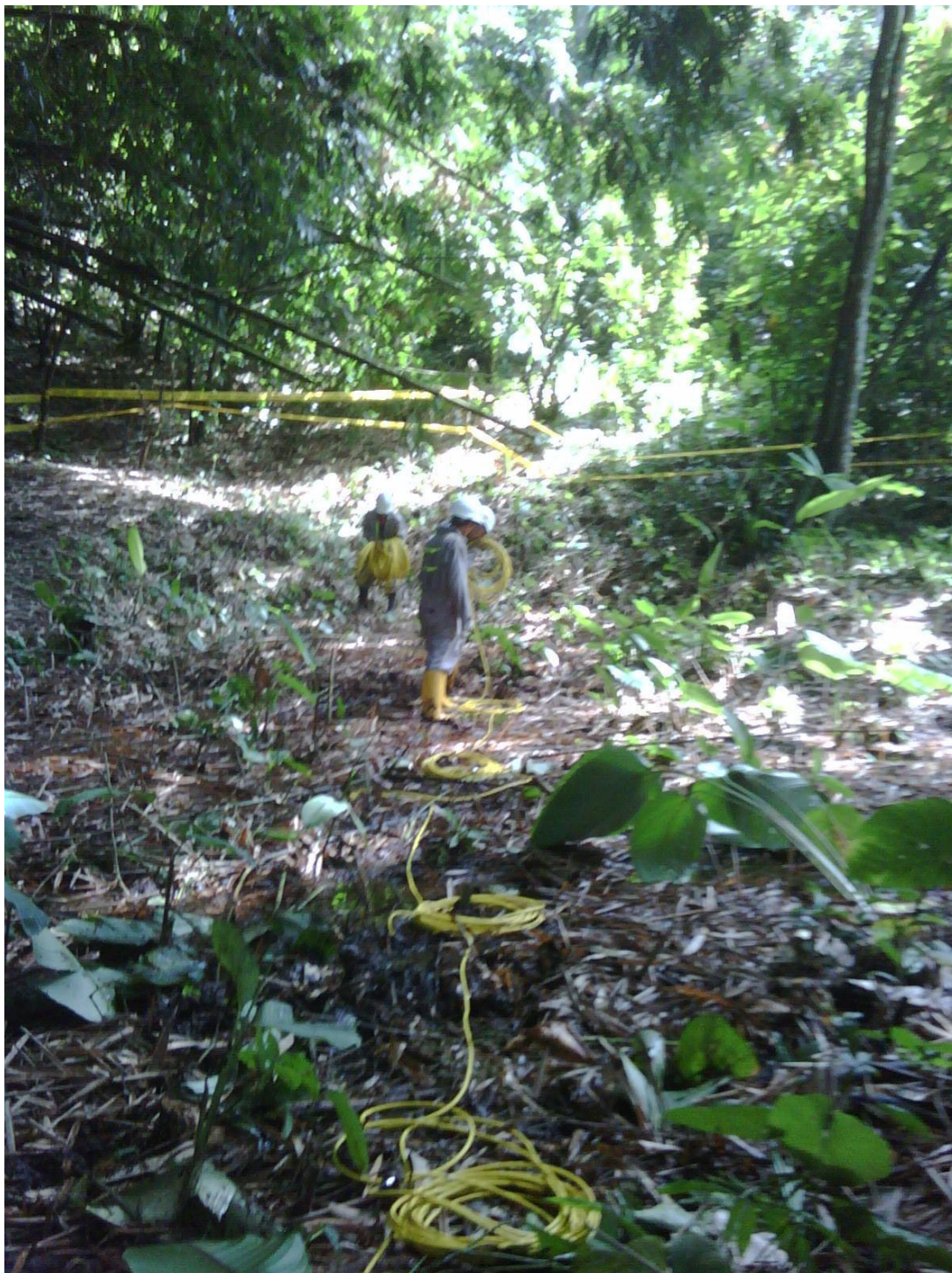
FOTO No. 17. Línea para prospección geoelectrica L7, Eje pasa sobre cauce de Río Cucaracha.
