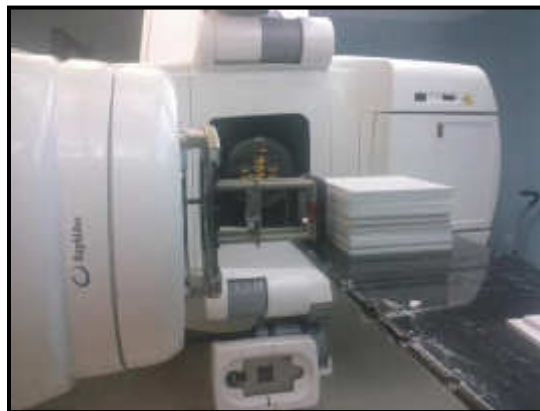
Figura 27. Arreglo de láminas de agua solida con placa gafchromic en el centro.
