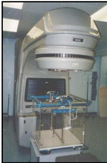
Figura 09: Esquema de irradiación a un fantoma de agua de 40 \times 40 \times 40 \text{ cm}^3 con el gantry a 0^\circ [7]
