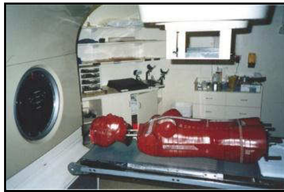
Figura 10: esquema de irradiación de un fantoma antropomórfico (Alderson Rando Phantom) seccionada transversalmente para estudios dosimétricos [7].
